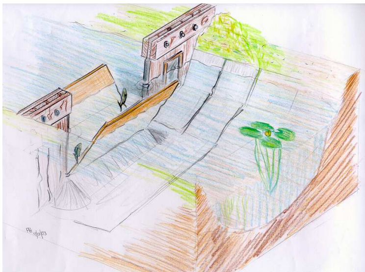
Figuur 3 Schets vispasseerbare stuw
