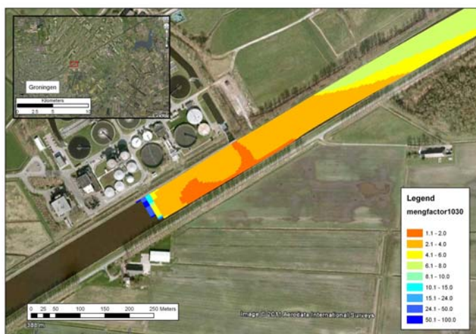
Figuur 9 Voorbeeld verdeling mengfactor aan het oppervlak van het Eemskanaal bij de rwzi-Garmerwolde, uitgaande van een, al enige tijd, stagnant kanaal.
