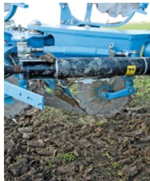
▲ Na het wentelen schuift de cilinder terug in de oude stand.
