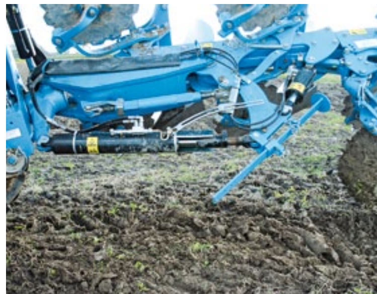
▲ De lange cilinder schuift helemaal uit, zodat de achterkant van de ploeg helemaal wegzwaait.
