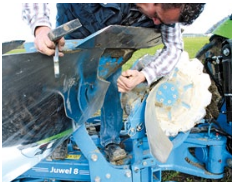
▲ Door de risterkant weg te halen, kun je het complete rister van het lichaam schuiven.
