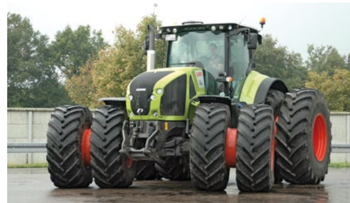
▲ 215 cm hoog rubber op de achteras en 170 cm op de vooras maken de kans dat de Axion 900 zijn vermogen op de bodem krijgt alleszins aannemelijk, zeker als dat gebeurt in combinatie met dubbellucht.
