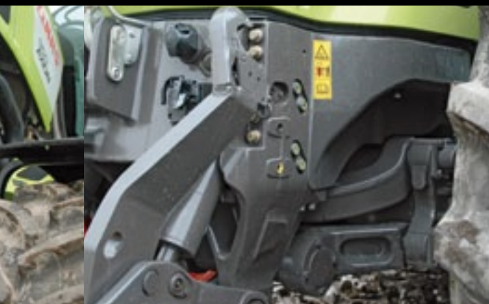
▲ Buitenbediening voor fronthef en een DW-ventiel. Voorasvering is een optie bij 40 km/h.
