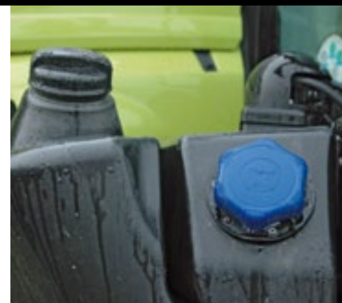
▲ Tanks voor dieselolie en AdBlue met een inhoud van respectievelijk 700 en 60 liter.
