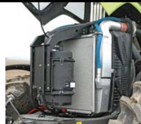
▲ Goede toegankelijkheid van de zescilinder FPT door een motorkap die als één geheel opent.
