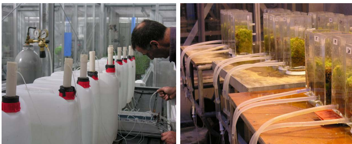
Figuur 3.1: Overzicht experimentele opstelling CO 2 -experiment. Links is de CO 2 -fles met de voorraadcontainers te zien en de slangenpomp, rechts de aquaria met veenmos. Foto: Juul Limpens.
