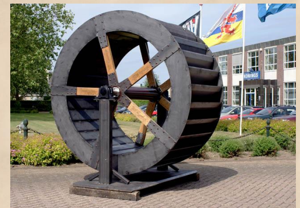
Afb. 26: Hier nog op een stelling, het grotendeels in staal uitgevoerde waterrad van de Cannenburghermolen.
