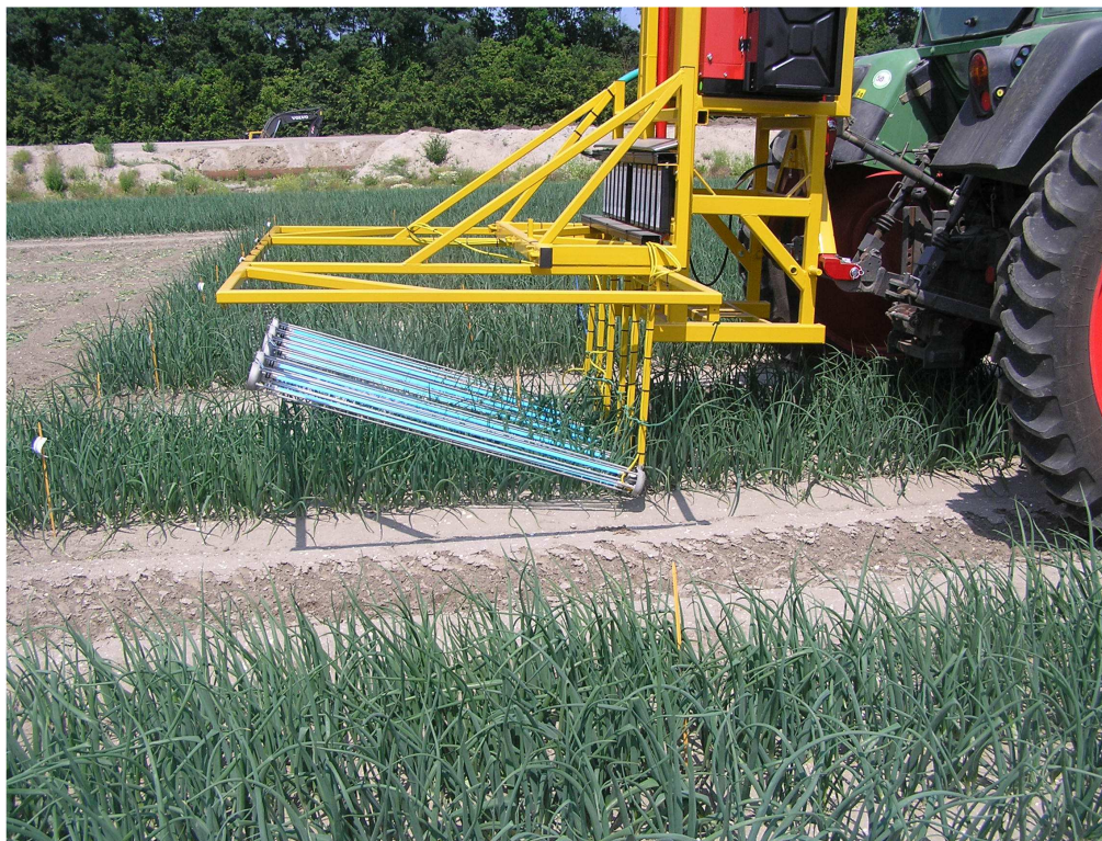
Figuur 1. Belichtingsmachine in uien op 1 juli.
