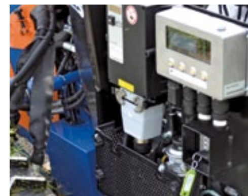
De bediening op de Irus zelf beperkt zich tot 'contact maken'. De rest gaat draadloos.
