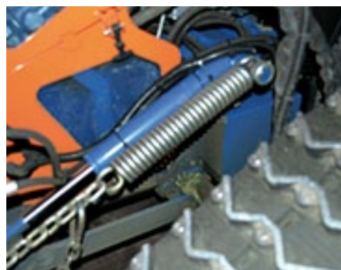
Trekveren aan het werktuigframe brengen gewicht (en dus tractie) over op de rupsen.
