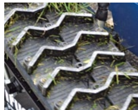
Metalen kammen op de rupsen zorgen voor maximale grip. Spikes vormen een optie.
