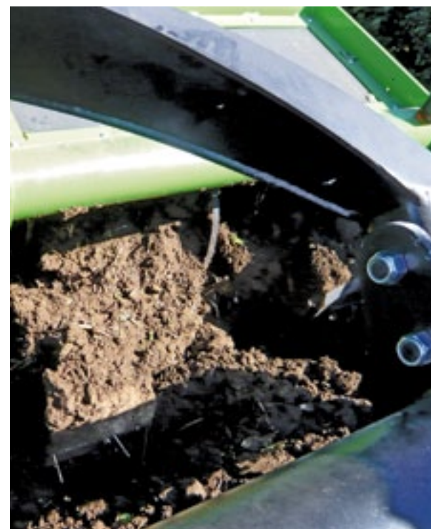
▲ Door die ristervorm keert de machine de grond om.
