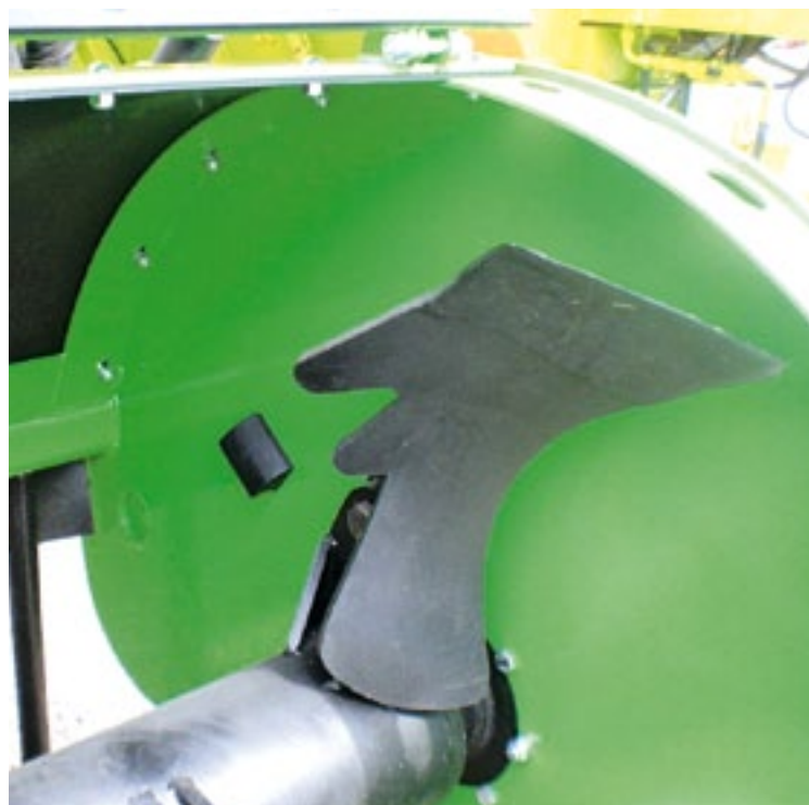
▲ De spaden zijn ristervormig.
