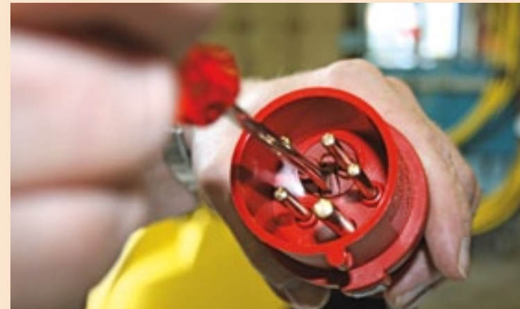
▲ Controleer de draairichting voor je de warmwaterhogedrukreiniger in bedrijf stelt. Die is van belang voor de aanjager/ventilator van de kachel, niet voor de pomp. De meeste warmwaterreinigers hebben een indicatielampje voor de draairichting. Er zijn 400 volt-stekkers te koop waarbij je met een schroevendraaier twee fasen omdraait. Kärcher levert ze bij zijn industriereinigers.
