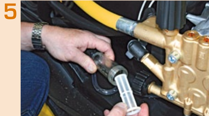
▲ Reinig regelmatig het water-fijnfilter. Maak daarvoor het apparaat stroom- en drukloos. Schroef het deksel van het filterhuis, haal het filterelement eruit en reinig die met schoon leidingwater of perslucht in tegengestelde richting van de waterstroom. Maak zo nodig het filterhuis schoon. Is er watertekort in de vlotterbak, neem dan de toevoerslang af en reinig de zeef in de aanvoer.
