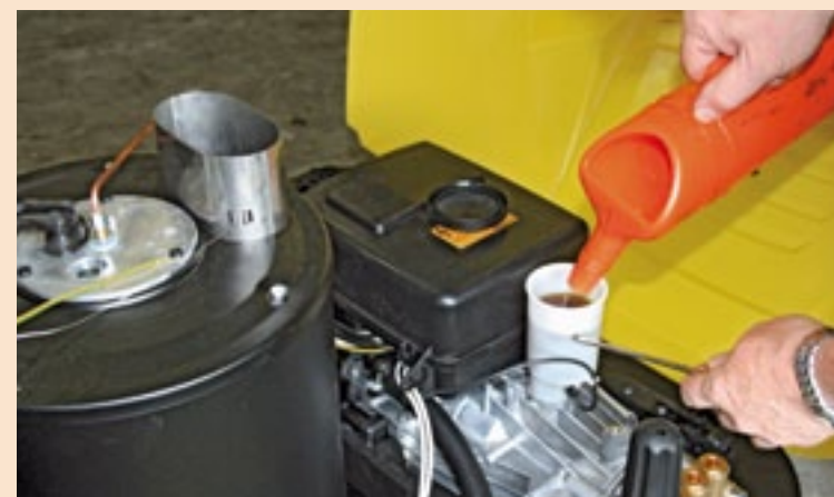
▲ In de aandrijving van de pomp zit ongeveer 0,75 liter 0W40 olie (raadpleeg uw handboek) die voor elk gebruik gecontroleerd moet worden. Op de pomp is een potje aanwezig met minimum- en maximumniveau. Zwarte olie duidt op inwendige slijtage; ververs de olie dan. Is de olie grijs/melkachtig van kleur, dan zit er water in de olie en lekt de pomp intern.
