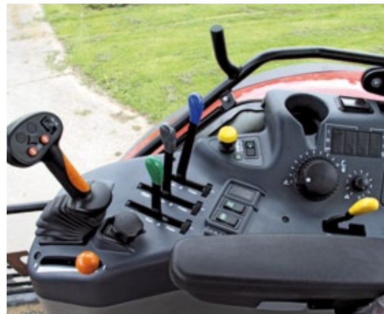
▲ De multifunctionele hendel links herbergt via knopjes de 8-traps powershift en de groepen. Ook de snelschakelaar van de hef zit op deze verstelbare pook. De bediening van de hydrauliek is vooral mechanisch.
