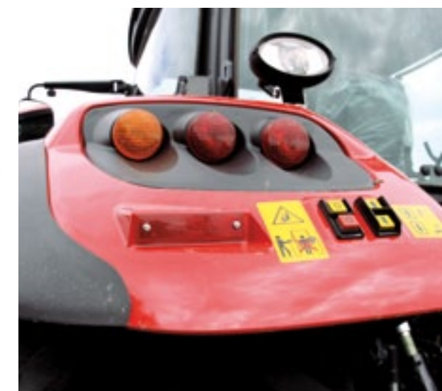
▲ Hef en aftakas zijn op beide achterspatborden te bedienen. Werkverlichting is ruim aanwezig.
