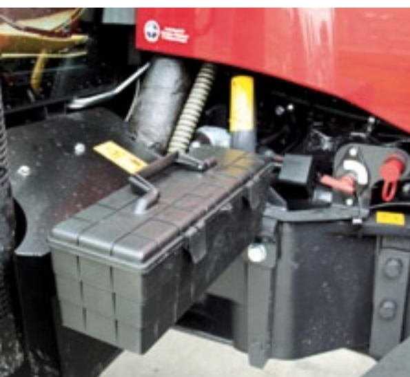
▲ Een gereedschapskist moet, maar hoort links voor de cabine. Rechts de massaschakelaar.
