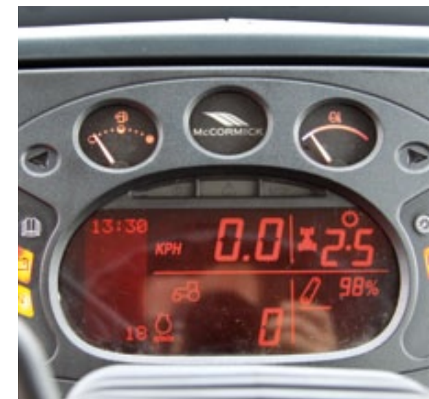
▲ Het digitale dashboard toont naast snelheid en toerentalen ook de hoogte van de hef.
