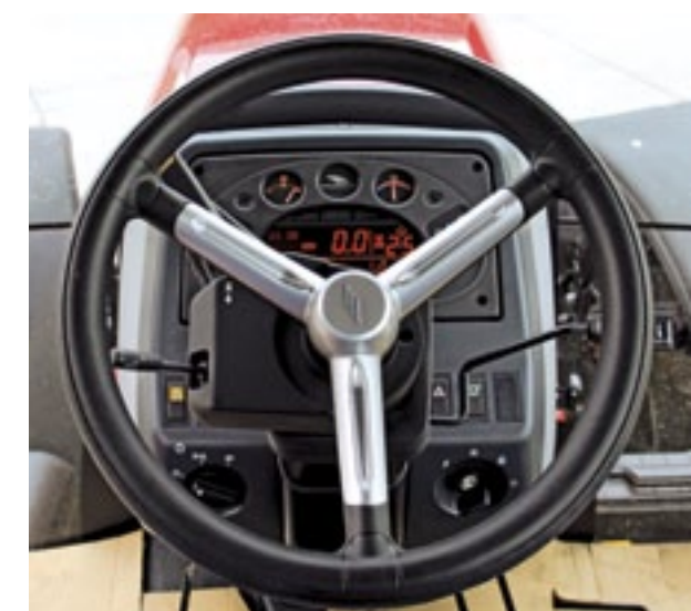
▲ Het sportieve stuurwiel vraagt drie omwentelingen van de ene uiterste stand in de andere.
