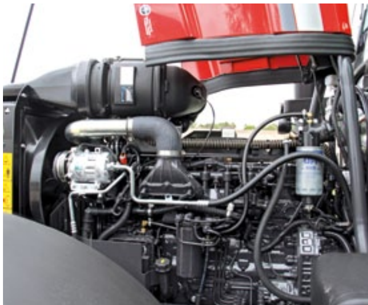
▲ De 6,7 liter common rail BetaPower van FPT combineert een ruim traject aan constant vermogen met voldoende koppeltijging en een laag verbruik. Volgens McCormick moet deze zescilinder maximaal 135 kW/183 pk leveren.
