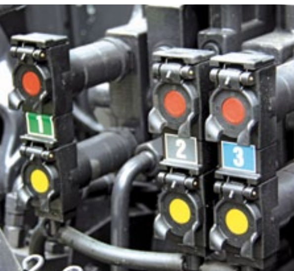
▲ Handige kleurcodering op de snelkoppelingen, maar als stickers niet erg duurzaam.
