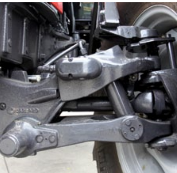
▲ De parallelle wielvering van Carraro (optie) biedt veel rijcomfort en ook veel vetnippels.
