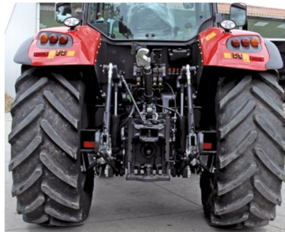
▲ Tussen de achterwielen biedt de XTX een ruime hoeveelheid hydraulisch vermogen, een snelverstelwagentrekhaak met zes standen, een kieperknobbel en een aftakas met 540/1000. De keuze voor drie toeren op de pto is helaas niet te maken. De hefkracht is voldoende, maar helemaal bovenin beperkt.
