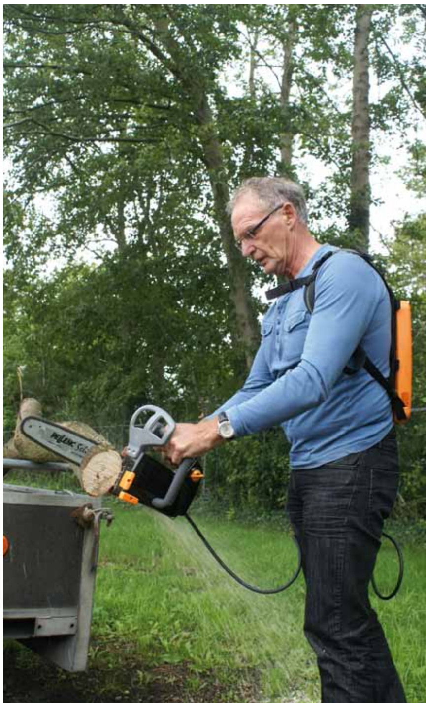
De elektrisch aangedreven kettingzaag is te vergelijken met een 40-cc-benzine-kettingzaag. Dat merk je niet als je erbij staat, want dan lijkt de zaag veel minder vermogen te hebben.
