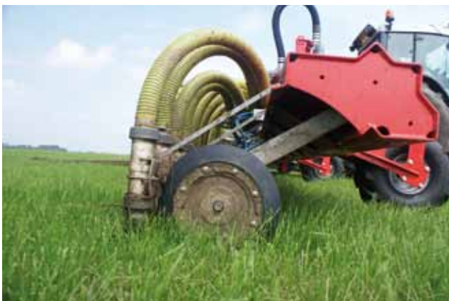
◀ De elementen met torsievering, parallelgeleiding, 35 centimeter grote kunststof snijschijven in combinatie met het nieuwe gezette hoofdframe met forse loopwielen met spindelverstelling.
