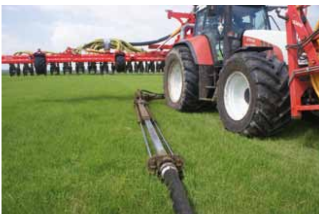
◀ Dankzij de dubbele knik kan de hydrotelescoop naast de trekker knikken om zo met de bemester achteruit te kunnen rijden om de laatste baan te trekken of de kopakker af te werken.
