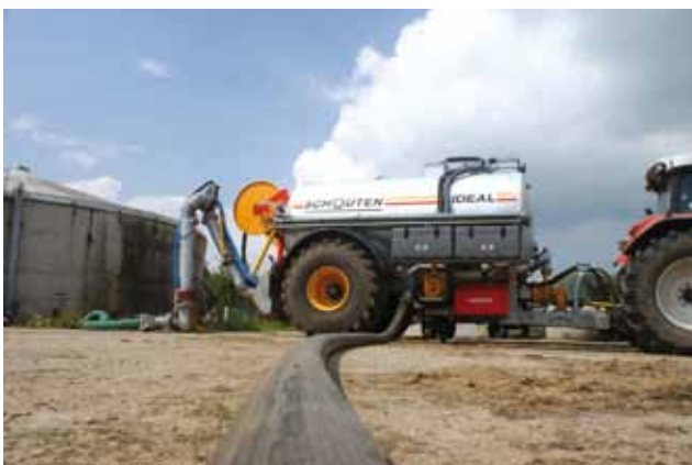
◀ De nieuwe pomptankwagen met radiografisch aangestuurde afsluiters voor het stoppen op de kopeinden en het rondpompsysteem om de pomp door te laten draaien.
