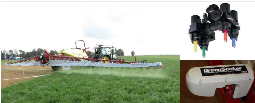
Figuur 1. Voorbeeld SensiSpray spuit met variabele dosering met op de spuitboom Lechler VarioSelect dophouders en de Greenseeker gewas sensoren.
