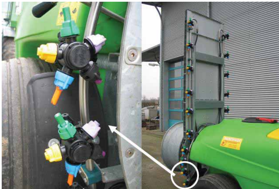
Figuur 2.6. Dwarsstroomspuit met detailopname draibare dophouders met de 5 gebruikte spuitdoppen in elke dophouder.
