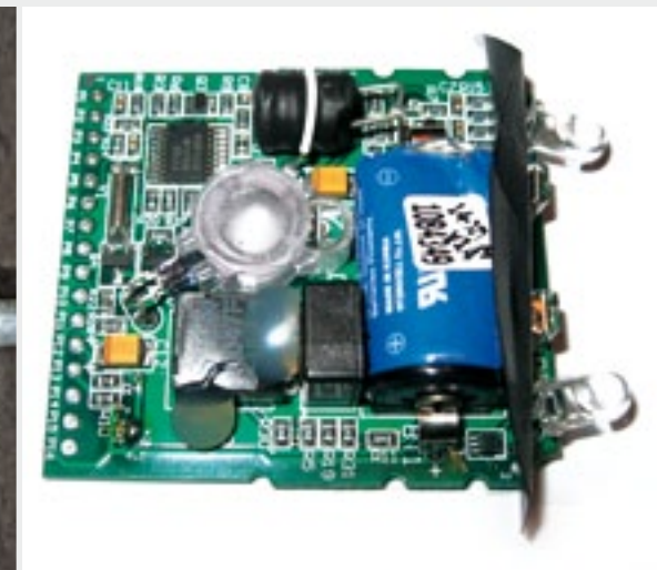
De binnenkant van de transponder. Te zien zijn de blauwe batterij, de witte bewegingssensor en leds voor infrarood dataverkeer.
