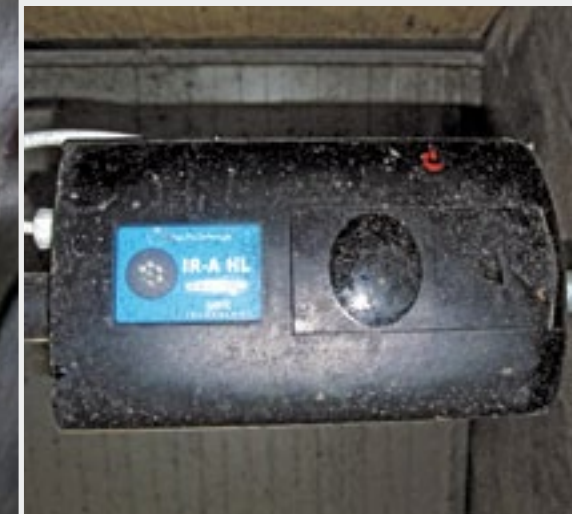
De antenne die in de stal hangt. Vaak wordt deze antenne geplaatst in de terugloopgang van de melkstal of boven een waterbak.
