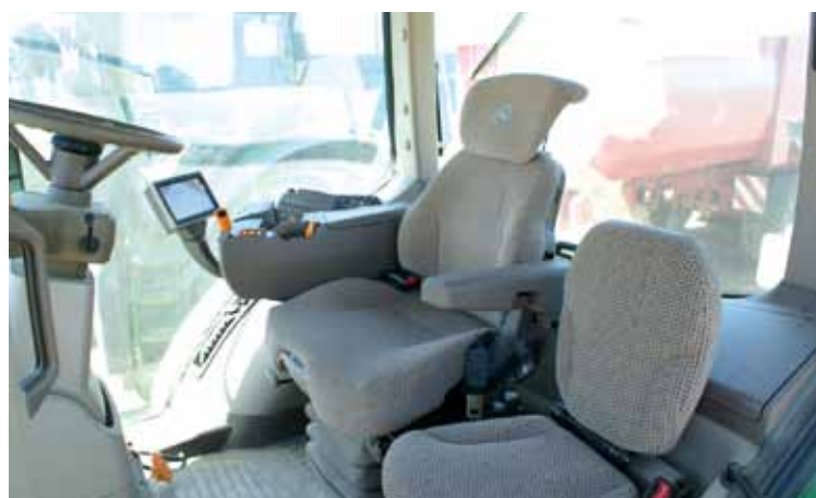
De vergrote cabine geeft ook ruimte voor een bredere rijdersstoel. De armleuning is nu vergelijkbaar in de 8R, de 7R en de 6R.
