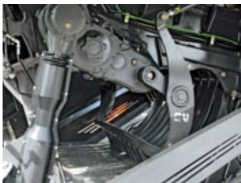
▲ De raffer stuwt het gewas in de voorkamer en met een verlengde slag in het perskanaal.
