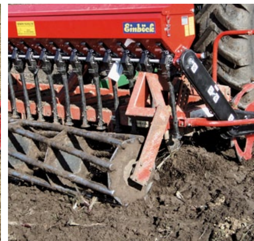
▲ Bij een mechanisch aangedreven opbouwzaaimachine drijft een loopwiel de nokkenas en raderen aan. Dat maakt de afgifte afhankelijk van de rijsnelheid.
