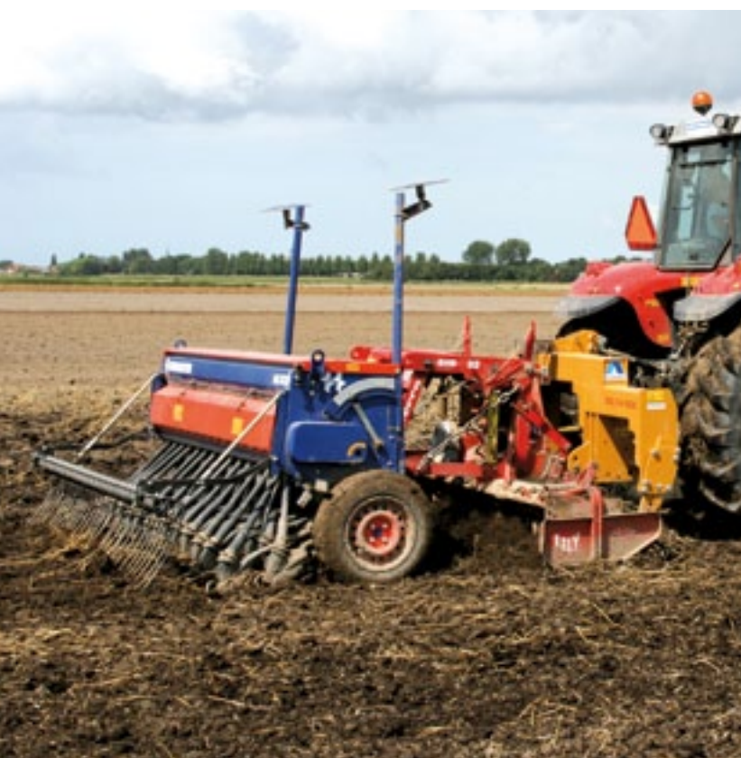
▲ Een mechanische zaaimachine met rotorkoep is een prima combinatie voor het zaaien groenbemester. Zeker als hij al in de schuur staat.
