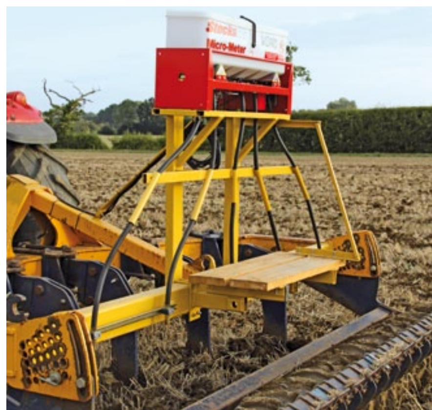
▲ Een pneumatische zaaimachine kan niet alleen groenbemester zaaien maar bijvoorbeeld ook koolzaad, direct in de stoppel.
