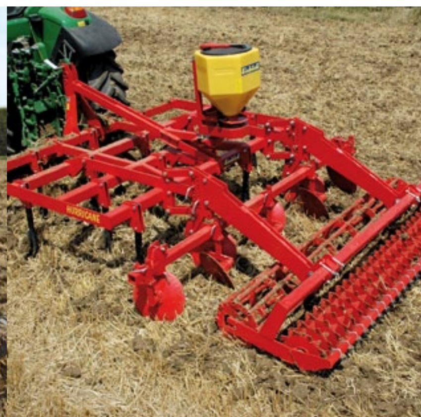
▲ Je kunt zaai zaad ook breedwerpig strooien met een elektrische zaaimachine. Je hebt dan wel dubbel zoveel zaai zaad nodig.
