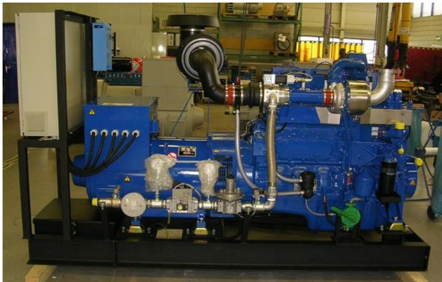
Figuur 2 — Voorbeeld van een mini-wkk
