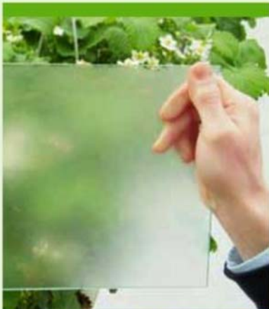
Het effect van de diffuse coating is goed zichtbaar.
