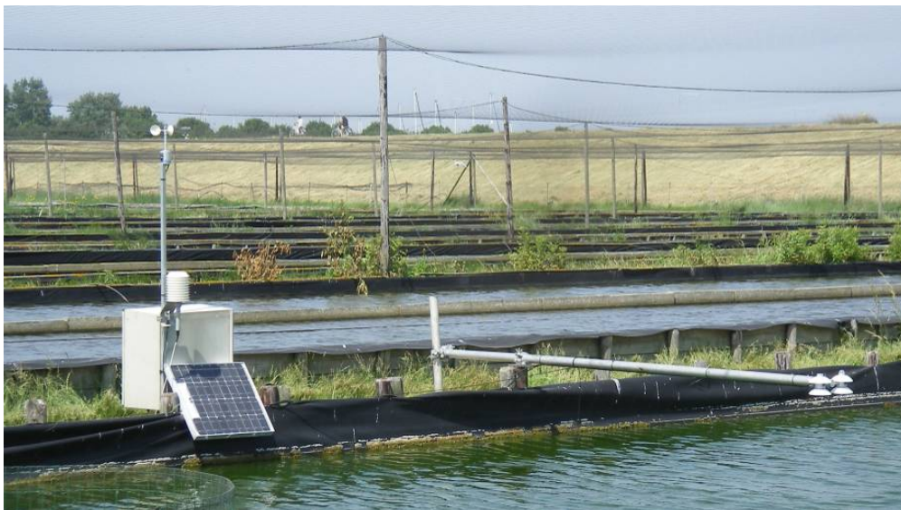
Figuur 3.2. Impressie van de meteorologische waarnemingen bij de zagervijver op het terrein van Topsy Baits in Wilbelminadorp. A: windsnelheid; B: luchttemperatuur en –vochtigheid; C: stralingscomponenten; D: zonnepaneel voor energievoorziening.
