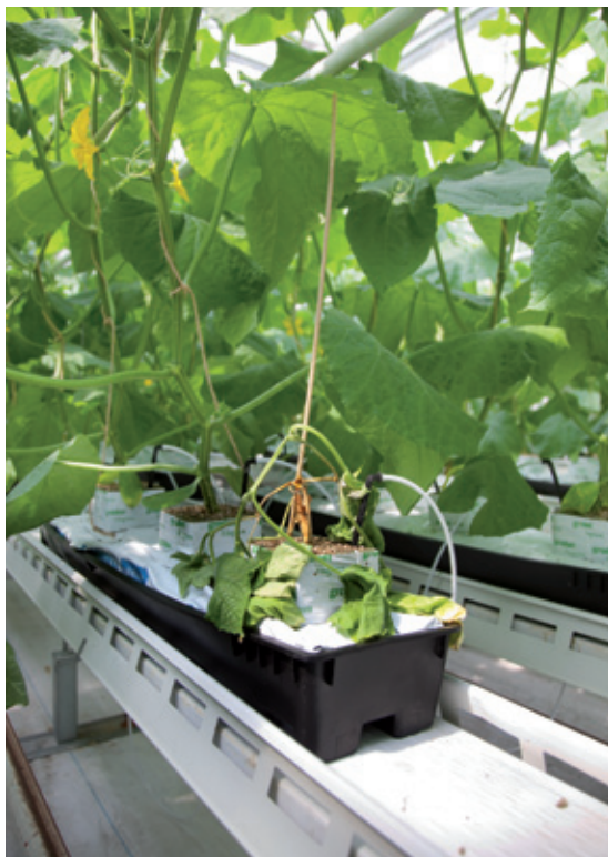
Biotoets voor het bepalen van weerbaarheid van steenwolmatten tegen Pythium in komkommer (links). Alleen de eerste plant wordt besmet. De snelheid waarmee de andere drie komkommerplantjes Pythium-symptomen laten zien is een maat voor substraatweerbaarheid. Bij de bodemweerbaarheidstoets (rechts) wordt elke pot besmet.
