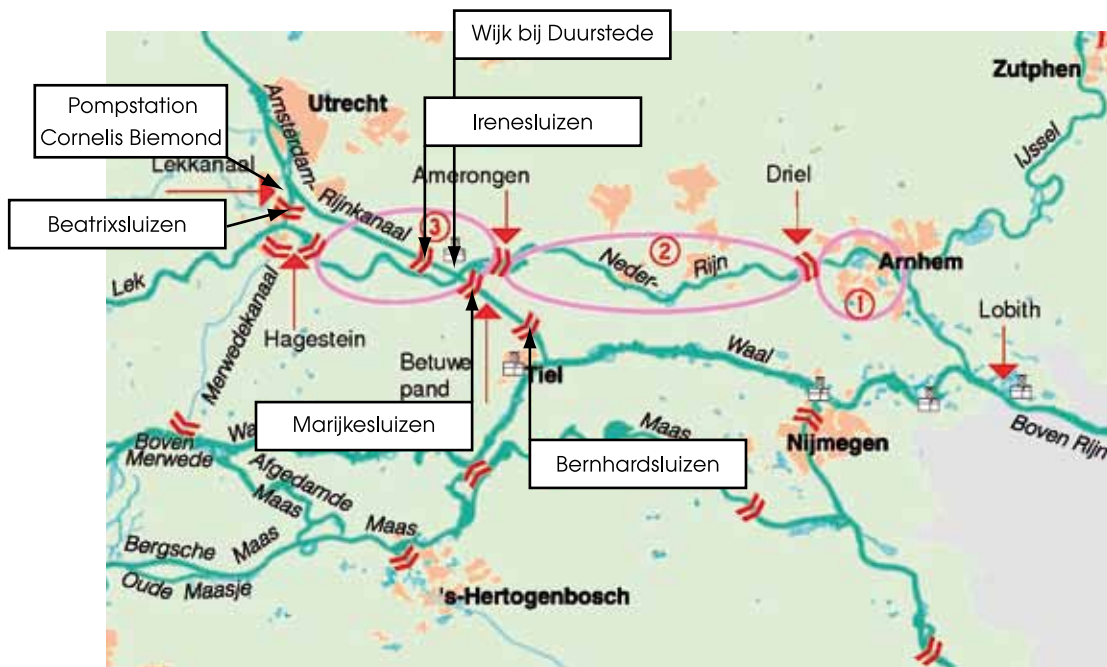
Abbeelding 1: Rijntakken met de stuwpanen Driel (1), Amerongen (2) en Hagestein (3), en de sluiscomplexen in het Amsterdam-Rijnkanaal.
