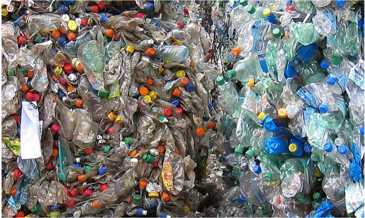
Vergelijking PET-flessen uit de inzameling van consumentenverpakkingen (links) met PET-flessen afkomstig uit de mono-inzameling (rechts); (Pretz, 2006)
