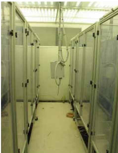
Opstelling zes begassingskasjes.
