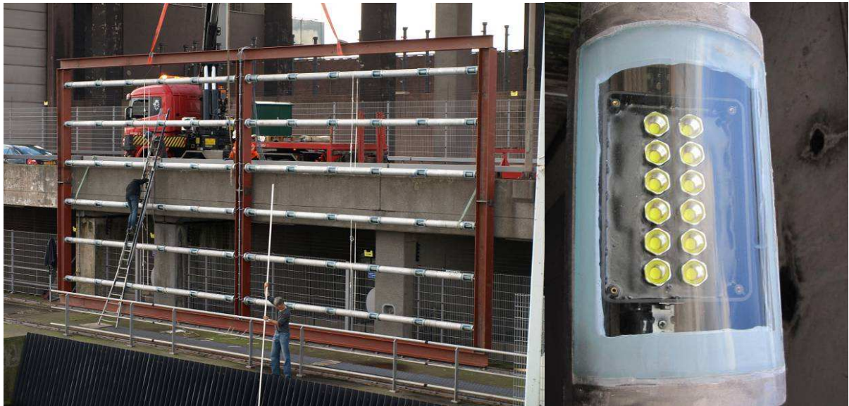
Foto 3.3.1 Het frame met de stroboscooplampen boven water (links) en een close-up van een lamp met 12 ledlichten (rechts).
