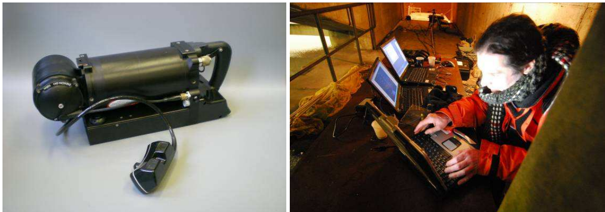
Foto 3.1.1. De DIDSON (links) en analyse van de DIDSON-beelden tijdens het meten (rechts).
