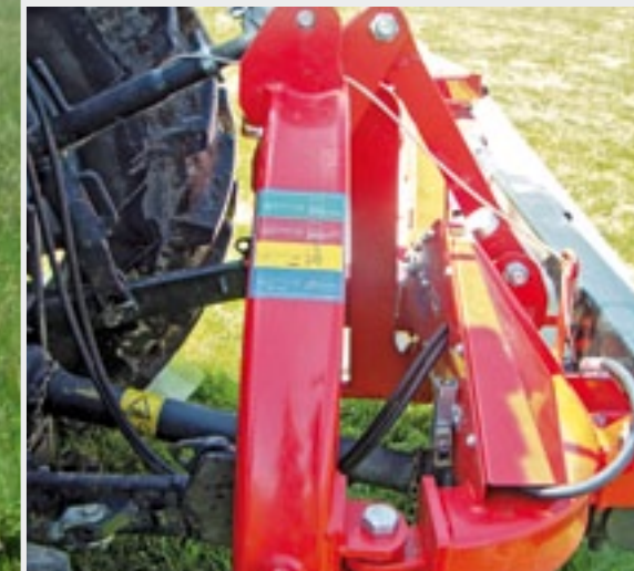
Het eerste scharnierpunt van het Twin Pivot-systeem. Het zorgt ervoor dat trekkerbewegingen niet aan de maaier doorgegeven worden.
