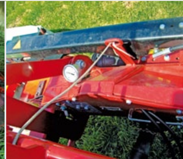
De bodemvolging is hydraulisch pneumatisch in te stellen.
