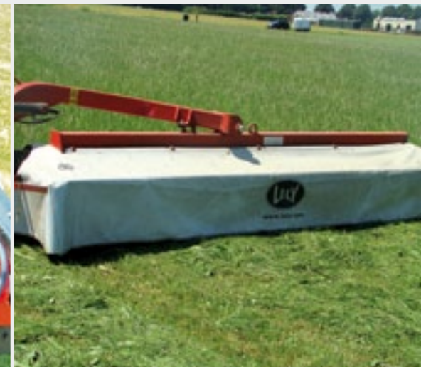
Het tweede scharnierpunt is in het midden boven de maaibalk te vinden. Daardoor is de maaibalk pendelend opgehangen.
