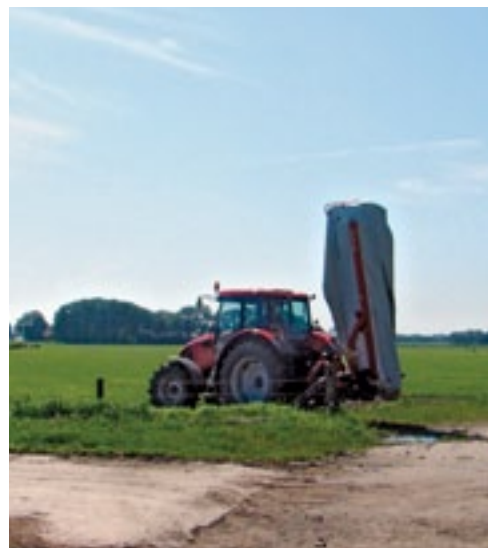
Toch is de machine tijdens transport nog altijd te hoog voor gebruikers van de maaier.
