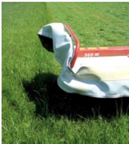
Het beschermdoek is op te klappen, zodat een lagere transporthoogte ontstaat.
