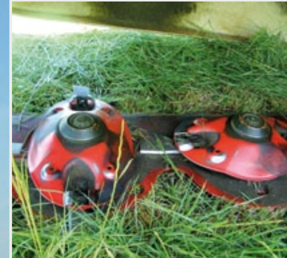
De messen van de schijvenmaaier hebben een grote overlap.
