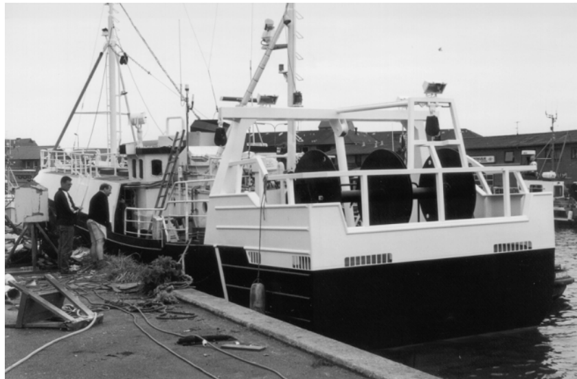
Het achterschip van een bestaande staandwantkotter wordt in het Deense Hvide Sande omgebouwd om te kunnen twinriggeren.
