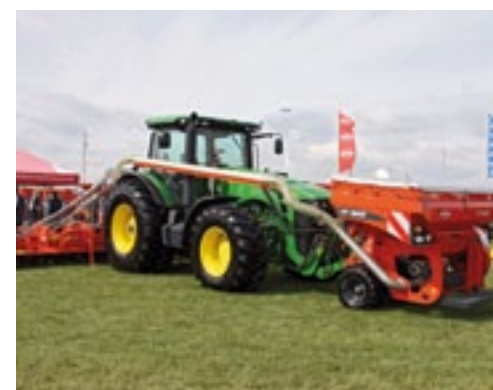
▲ Zaaitechniek die misschien geschikter is voor Nederland, was op de stand van Kuhn te vinden. De nieuwe CSC 6004 zaaimachine is gericht op grote bedrijven met veel hectares. De combinatie gebruikt de HR 6004 DR rotorkoep en Venta zaaitechniek. De Seedflex zaaikouters zijn nieuw en bestaan uit twee rijen dubbele schijven met een rijafstand van 35 cm die aan een parallellogram zijn gemonteerd. Achter iedere kouter zit een rubberen aandrukwieltje. De kouterdruk is instelbaar tot maximaal 45 kg. Voorop de trekker hangt een fronttank van 1.500 liter. Met opzetranden is dit uit te breiden naar 2.000 liter. De CSC is momenteel alleen leverbaar als machine van 6 meter en kost 75.000 pond inclusief fronttank.
