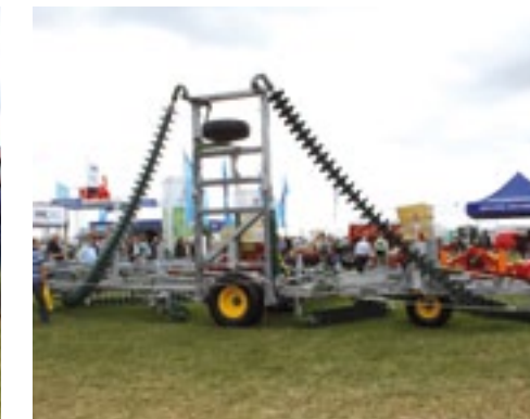
▲ Om grote hoeveelheden stoppel in een korte tijd te kunnen bewerken, haalde de Engelse firma Weaving de Kelly Multi Purpose Harrow vanuit Australië naar Engeland. Deze schijveneg wordt al op verschillende plaatsen in Europa gebruikt en onder licentie in Denemarken gebouwd door KK Europe. De machine bestaat uit een aantal rijen kettingen met daaraan kleine schijven. De machine is leverbaar in werkbreedtes van 6, 9 en 12 meter. Hiermee is 7 tot 13 hectare per uur te bewerken. Per hectare komt dat neer op 2,5 tot 3,5 liter diesel, claimt de fabrikant. Voor transport over de weg vouwt de hele combinatie zich op tot 3 meter breedte. De versie van 6 meter kost 36.000 pond exclusief btw.
