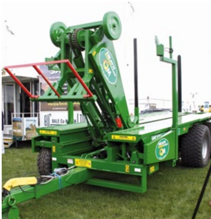
▲ Big Bale Company North toonde de verbeterde SuperChaser QM balen-verzamelwagen van Heath. Hierop passen pakken van 120x130 cm. Door de strovork te wisselen, zijn ook kleinere balen te laden van 120x90 cm tot 80x70cm. Van de 120x90 pakken passen er 14 op de wagen en van het kleinste formaat zelfs 27. Alle functies worden vanaf de trekker hydraulisch bediend. Inmiddels draaien er in Nederland twee van deze verzamelwagens.
