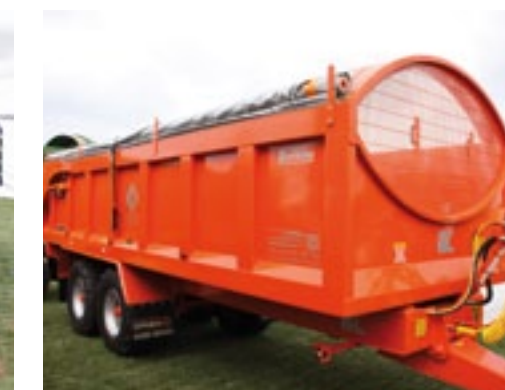
▲ De Rootking kipper van het Engelse merk Larrington Trailers is speciaal geschikt voor gewassen als aardappelen en uien. Dit betekent dat de bak laag en lang is. Verder is de Rootking vrij luxe uitgevoerd ten opzichte van de gewone graankippers in Engeland. Hiermee komt het merk meer overeen met kipwagens die wij in Nederland gewend zijn. Voor goed zicht in de bak is het doorkijkrooster vervangen door een groot ovaalvormig voorschot. Voor graan is het voorschot af te dekken met een plexiglas plaat. De boog steekt, net als de achterklep, 45 cm boven de bak uit. Hierdoor kan er gemakkelijk een zeil over de kipper gerold worden. Optioneel kan dat ook automatisch. Rondom is de kipper geheel voorzien van ledverlichting.
