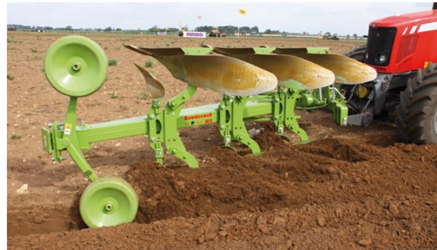
▲ De Engelse ploegenfabrikant Dowdeswell showde het prototype van zijn 105 P Series MA duwploeg. Dit is een variant van de bestaande 105-serie. Tot twintig jaar geleden zat er een duwploeg in het gamma, maar zonder veel succes. Waarom blijkt wel uit de demonstratie. Op het demoveldje hadden de technici veel moeite om de ploeg netjes af te stellen. Een versie met drie scharen en breekboutbeveiliging kost ongeveer 11.700 pond. Een twee- en vierschaarversie zijn ook leverbaar.
