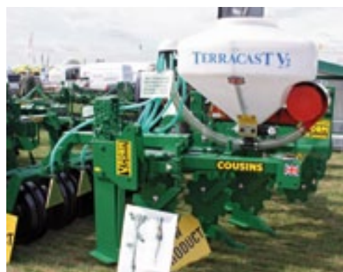
▲ Diep woelen en direct koolzaad zaaien in de stoppel is in Engeland populair. Boeren bouwen hiervoor vaak zelf een zaadtank achterop een diepwoeler of cultivator. De plant hoeft zo weinig moeite te doen om diep te wortelen. Fabrikant Cousins paste zelf zijn V Form aan. De 3 meter brede machine heeft vijf of zeven tanden van 60 cm en een rijafstand van 60 of 43 cm. Vóór elke tand is een gekartelde schijf te monteren; die voorkomt ophopen van gewasresten. Bovenop zit een Terracast V2 pneumatische zaaimachine. Die wordt elektrisch aangedreven en blaast het zaad in een 15 cm brede strook achter iedere woelpoot. Een pakkerol drukt de grond aan. De V Form met zeven tanden zonder schijven kost 18.140 pond.
