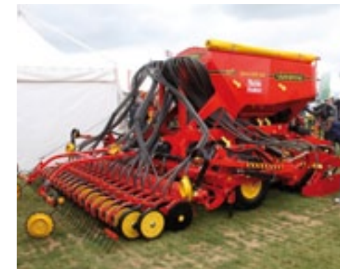
▲ Een van de populairste merken in zaaiteknik en grondbewerking voor Groot-Brittannië is het Zweedse Väderstad. Tijdens Cereals liet het zijn nieuwe Spirit 400C SDC Next zaaimachine zien. SDC staat voor System Disc Combi. De machine is vooral bedoeld voor lichtere grond en combineert het zaaien van kunstmest en zaad. Ook kan een mix van twee gewassen worden gezaaid. Dit voorjaar zijn de eerste machines van 4 meter in Schotland getest. De machine combineert twee rijen schijven met vlakborden, pakkerwielen en een dubbele rij V-vormige kouters met een rijafstand van 12,5 cm. De tank van 3.900 liter bestaat uit twee delen: een deel van 1.925 liter voor zaai-zaad en een deel van 1.975 liter voor kunstmest.
