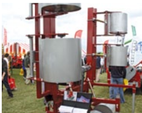
▲ De Scotts Ridgepress 6x30/40 is een speciale aandrukrol voor aardappelruggen. Hij is gebouwd door de Engelse fabrikant Scotts die zich specialiseert in machines voor de aardappelteelt. Scheuren in een aardappelbed kunnen na het loofklappen zorgen voor onnodig groene aardappelen. Om deze scheuren te dichten, werd de Ridgepress gebouwd. Die heeft zes stalen rollen om de grond te verkruimelen en de rug dicht te drukken. De rollen zijn aan een centrale balk gemonteerd en te verschuiven tussen 75 en 100 cm. Met een veer is de druk in te stellen. Voor wie dat niet genoeg is, zijn de rollen ook nog met water te vullen.
