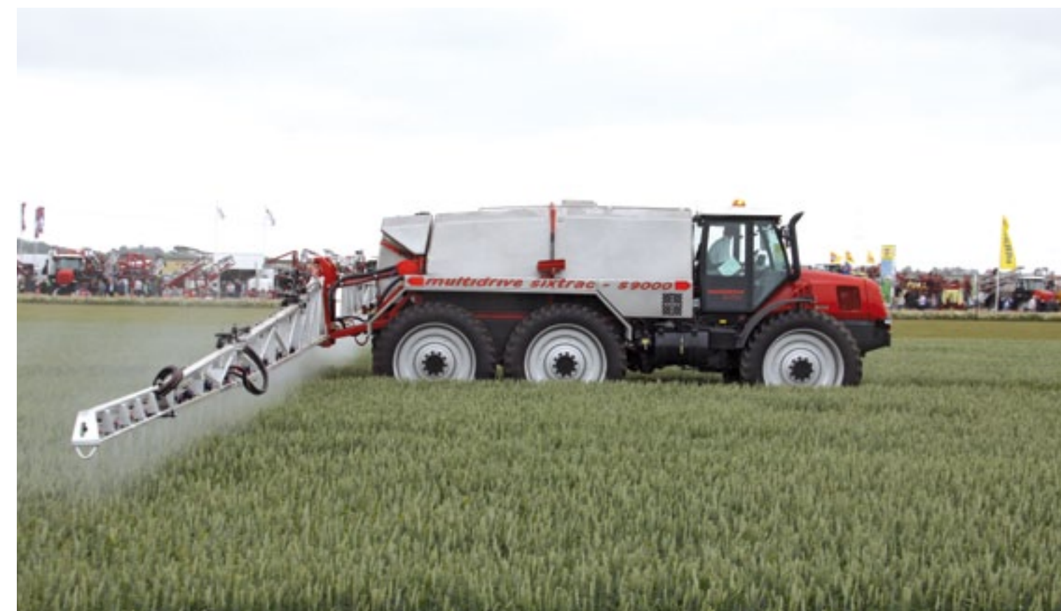
▲ Fabrikant Kellands demonstreerde zijn imposante Multidrive Sixtrac met een 9.000 liter veldspuit. Deze zeswielige werktuigdrager wordt mechanisch aangedreven en heeft een 266 pk motor van John Deere en assen van Spicer. De transmissie is een powershift met elf trappen. Maximaal kan de Sixtrac 14,5 ton dragen. De spuit wordt door Kellands zelf gebouwd. Bomen tot een breedte van 36 meter zijn leverbaar en komen bij het Franse Pommier vandaan.
