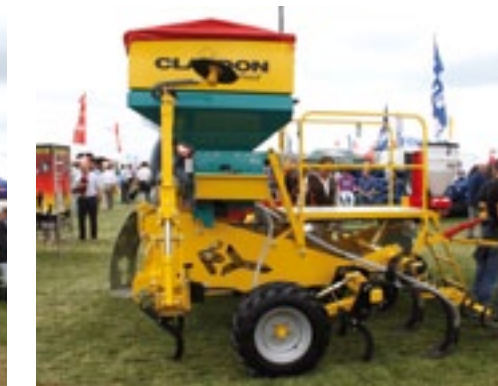
▲ Akkerbouwer en machinebouwer Jeff Claydon bouwt al sinds de jaren negentig zogenoemde strip-till zaaimachines. Die zaaien gewassen, zoals graan of koolzaad, op een rijafstand van 30 cm en bewerken alleen de grond waarin gezaaid wordt. Voor de kleinere bedrijven is er nu ook een 3 meter brede versie van de Hybrid zaaimachine leverbaar. Een trekker van 150 pk volstaat om met deze machine overweg te kunnen. Twee rijen tanden maken de grond los waarna een breed zaikouter het zaad in een brede band zaait. Standaard gebruikt de Hybrid het zaadverdeelstelsel van Sulky. Optioneel is het elektronisch aangedreven Accord systeem. Prijzen beginnen bij 33.000 pond.
