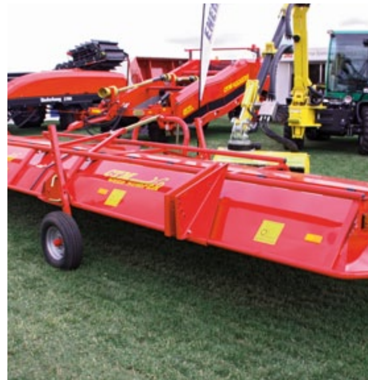
▲ De Weed Surfer van fabrikant CTM is een lichte bloter om in een staand gewas, zoals suikerbieten, schieters of onkruid af te maaien. Je kunt er ook een groenbemester mee kort houden. Er is een versie van 6,4, 8 en 10 meter leverbaar met tien of veertien rotors. De versie van 8 meter weegt 700 kg en werkt op een hoogte van 30 cm. Dit is aan te passen tot 85 of 100 cm. Hij kan voor- en achterop en heeft een 1.000-toerige aftakas nodig.
