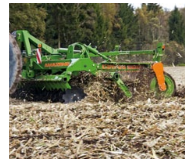
▲ De Catros+ van Amazone bestaat uit twee rijen gekartelde schijven met daarachter een aandrukkrol naar keuze.
