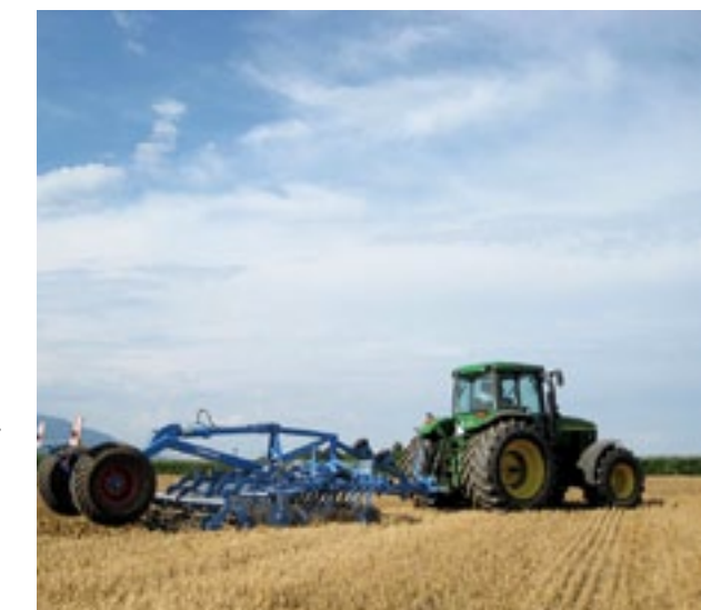
▲ De Rubin schijveneg van Lemken heeft twee rijen gekartelde schijven die individueel zijn opgehangen.
