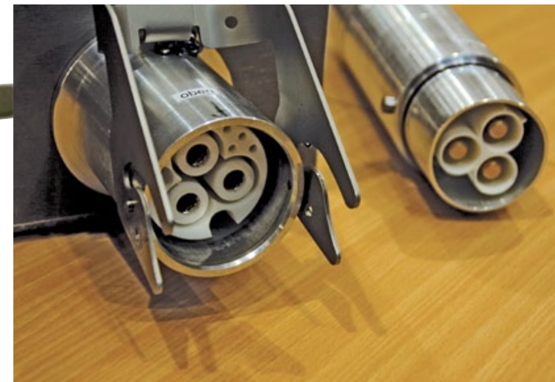
▲ John Deere toonde op de NVTL-studiedag op 1 maart jongstleden in Wageningen deze nieuwe koppeling voor het overbrengen van arbeidselektriciteit tussen trekker en werktuig.
