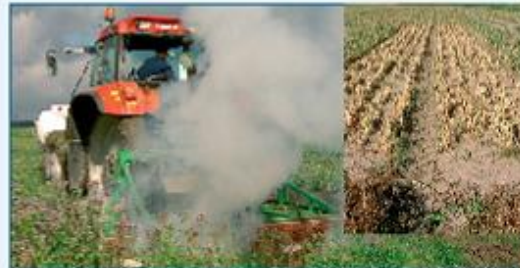
Uienloof gebrand op 15 cm hoogte en een rijsnelheid van 1,5 km/h
