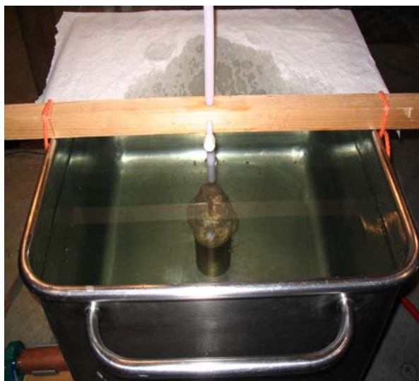
Foto 1. Biet met klei in de wortellijst onder water geplaatst met de staartpunt naar boven, waarbij de PEF-ontlading door de biet heenging.
