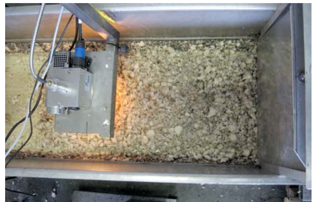
Foto 1. Bovenaanzicht van de transportband met verkleind bietenmateriaal met daarboven de meetkop met verlichting.
