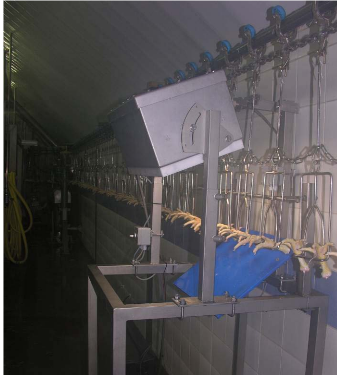
Figuur 6. Plaatsing van het camerasysteem bij slachterij 3. Het eerste scharnierpunt van de haak bevindt zich net boven de haak, ter hoogte van de ketting. Het tweede scharnierpunt net onder de rails waarover de haken lopen, onder de ketting.
