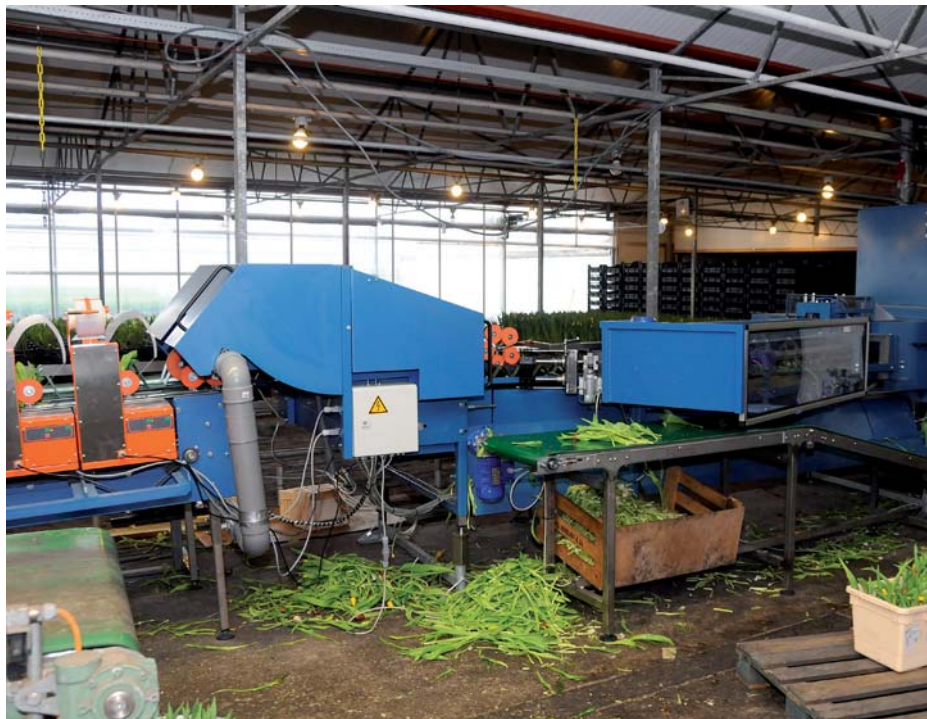
De Tulipstar heeft een capaciteit van 14.000 stelen per uur
