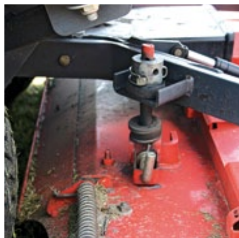
De maaierhoogte is instelbaar op zeventien maaierhoogtes. Deze stel je zowel bij de voor- als achterwielen in. De scalpeerwielen hoeft je nauwelijks te verzetten.
