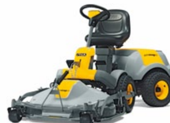
GGP Germany lanceert de Stiga Park Mirage 5.0. Deze Zweedse frontmaaier werkt op 48 volt loodaccu's waarmee je zo'n 75 minuten kunt maaien. Sterk punt: geen uitlaatgassen en geen lawaai. Op het display is te zien hoe vol de accu's nog zijn. Hij is voor tuinen tot 2.000 m². Het combimaaiddek is 95 cm breed en de prijs is 7.500 euro inclusief btw.
