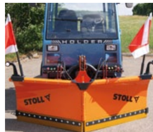
Op de stand van Stoll is de nieuwste sneeuwschuif van het bedrijf te zien met gasdempers om schokken van de weg op te vangen. Hierdoor kan er tot 60 km/h gereden worden. De SSS- en SVS-serie zijn er van 2 tot 2,4 meter en te koop vanaf 2.500 euro.
