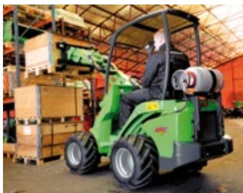
Avant lanceert de 525 LPG. Deze 1,2 tons minilader heeft een 17 kW (23 pk) Kubota dieselmotor die op propaangas loopt. Hij is 99 cm breed en tilt 800 kg tot 279 cm hoog.
