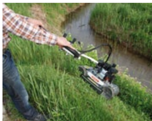
Hercules toont de SP1000 4WD van het Japanse Orec. Dit is vierwielangedreven gazonmaaier voor taluds tot 45 graden. Hij kost in Duitsland 4.190 euro inclusief btw.
