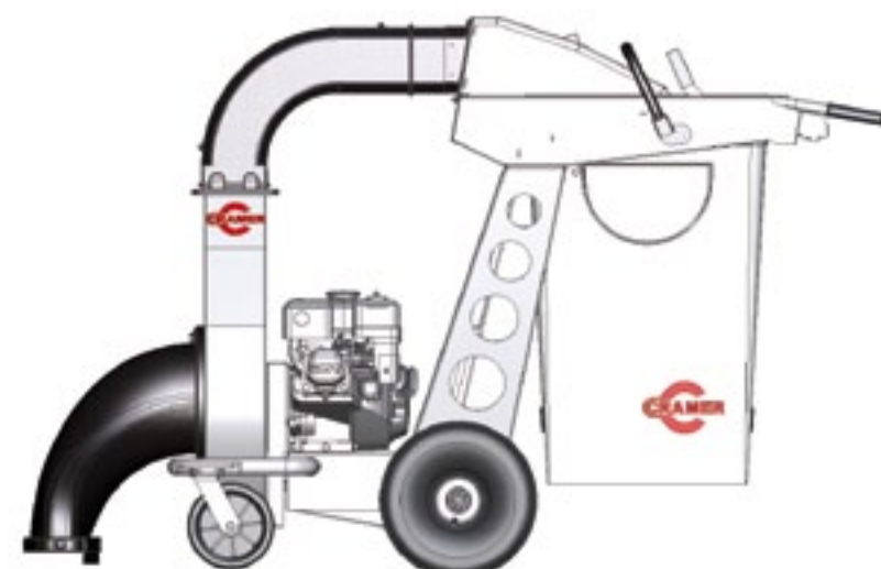
Een primeur van Cramer is de LS5000XP. Dit is een bladzuiger met opvangzak die je gemakkelijk kunt legen. Via een hendel zakt het motortoerental en sluit de afvoerpijp. De motor blijft lopen. Met een andere hendel open je de stofdichte parallellogramafsluiting en is de zak eenvoudig te legen.
