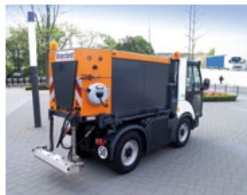
De Epoke pekelsproeier op deze M27 Tremo Carrier sproeit tot 3 meter breed. Door pekels – zout vermengd met water – te sproeien, is tot de helft op strooizout te besparen.
