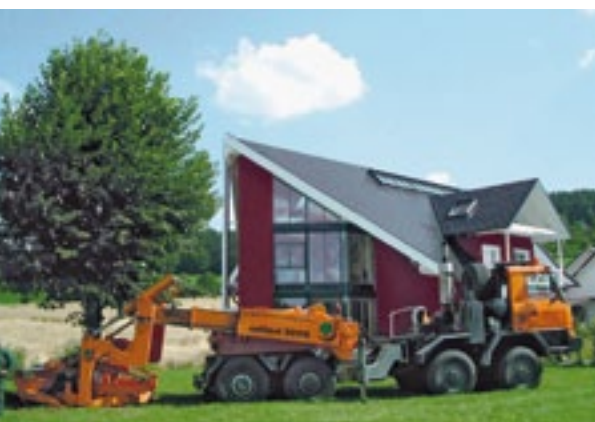
De Optimal 3000 van de firma Opitz verplant op de beurs een grote mammoetboom (Sequoiadendron giganteum). De Optimal boomrooier is op een vrachtwagen gebouwd en kan kluiten aan tot 3 meter in doorsnee.
