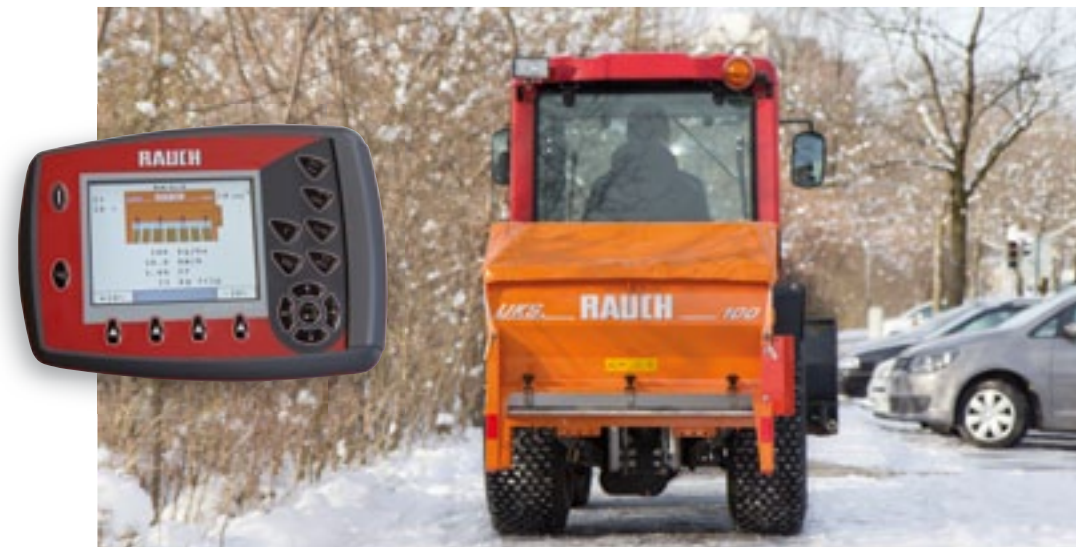
Rauch lanceert de UKS tapijstrooier met elektronische aansturing middels Quantron-A monitor. Hiermee wordt automatisch de strooihoeveelheid aangepast aan de rijsnelheid. Sta je stil dan gaan de toevoerschijven dicht. Alle handelingen zijn op te slaan. De UKS (80/100/120 cm) is er vanaf 2.500 euro.
