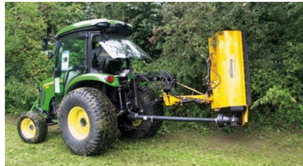
Müthing lanceert de FM/S zijklepelmaaier van 120 tot 160 cm. Die kan ook 90 graden omhoog en 60 graden naar onderen maaier. Ook toont Müthing het hydraulische drukontlastingssysteem Sofa voor de fronthef. Die tilt de klepelmaaier iets zodat er meer druk op de vooras komt. De kit kost 700 euro.
