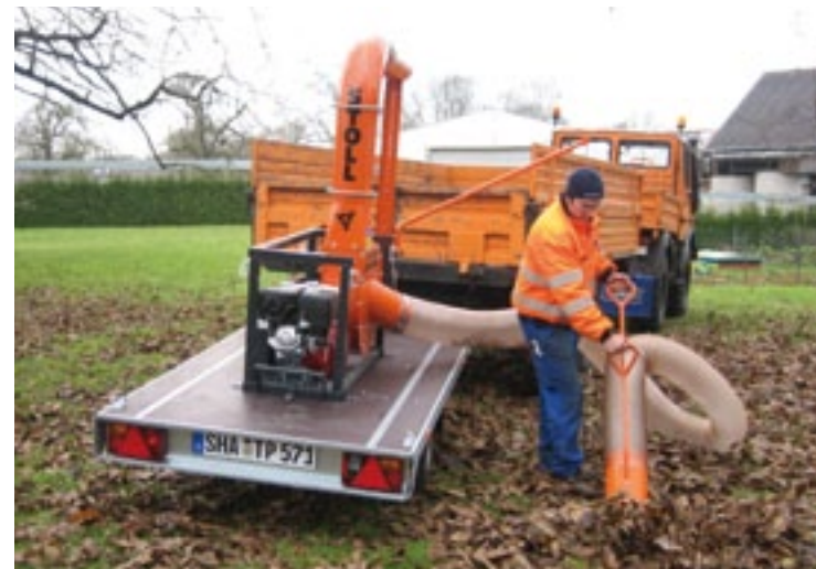
De Stoll LVG bladzuigen zijn bijvoorbeeld aan of op een aanhanger te plaatsen. De grootste LVG 372 met 13 pk Honda weegt 350 kg, heeft een 5 meter lange zuigslang van 20 cm doorsnede. Deze kost zo'n 4.000 euro.
