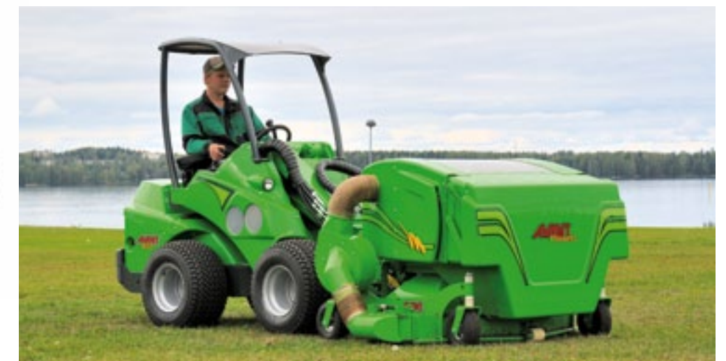
Avant heeft weer een nieuw aanbouwwerktuig: een 150 cm breed maaidek met 900 liter opvangbak. De bak is elektro-hydraulisch te legen tot 2,4 meter hoog. De ventilator zit dicht op de zijafvoer en is ook af te sluiten, zodat je kunt mulchmaaien. De prijs is circa 6.500 euro.
