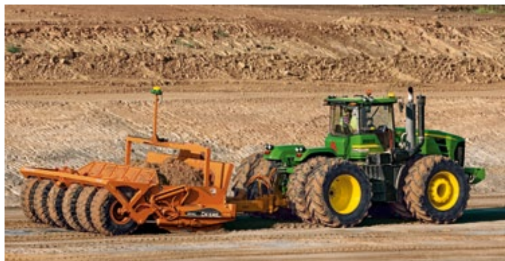
John Deere presenteert iGrade. Dit is een rtk-gps-systeem waarmee met een kilverbak een voor-geprogrammeerd profiel, zoals een heuvelige golfbaan, eenvoudig aangelegd kan worden.
