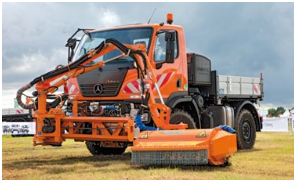
Mercedes-Benz pakt groot uit. Het toont 25 Unimogs, van maaiwerk tot winterwinst. De U20 is nu met achtrups kruip leverbaar. Naast 110 kW (150 pk) is de U20 er nu ook met 130 kW (177 pk) motor. De optionele frontaftakas is sterker. Deze mechanische pto levert nu 160 pk op het zwaarste type.
