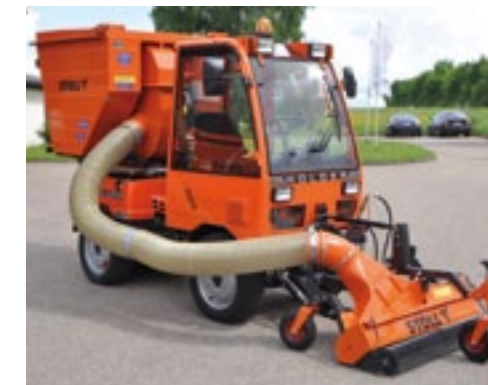
Fabrikant Stoll lanceert een zuigopbouw aan een Holder met opvang voor diverse ondergronden. De SHV 1200 zuigbek veegt vuil mechanisch op met een borstel of veertanden. Voorop zit een rol die automatisch de hoogte van de zuigbek aanpast afhankelijk van zuigkracht. Hij werkt 120 cm breed en weegt 92 kg. Optioneel is een hakselunit, zijbezem en verticuteerwals.
