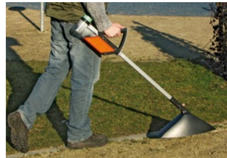
Mantis heeft de Mini Mantra Plus handspuit verbeterd. Het 0,5 liter tank met onverdunde glyfosaat is voldoende voor 5.000 m². Bij de HQ zijn de kabels weggewerkt. Hij kost tussen 495 en 549 euro.
