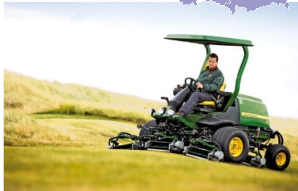
Nieuw van John Deere is de Hybrid 8500 E-Cut. Dit is een vijfdelige fairwaymaaier met hybride aandrijving. De 41 pk dieselmotor drijft tevens een aggregaat aan voor elektromotoren van de kooien. De motor draait op laag toerental. Dit geeft minder geluid en tot 30 procent brandstofbesparing.
