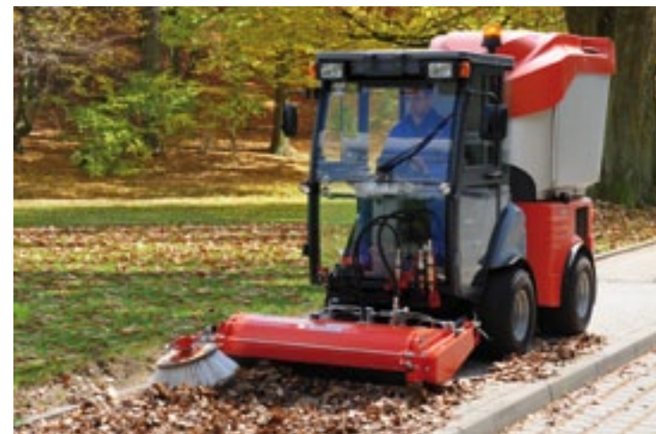
Voor een Hako Citytrac toont Fiedler een veger met middenafzuiging naar de opvangbak. Een borstel of veertanden vegen het blad en vuil op van verschillende ondergronden. Een hakselunit verkleint het materiaal.
