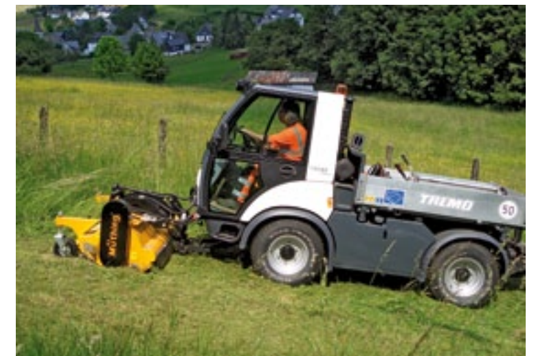
Müthing heeft een hydraulische klepelmaaier voor transporters gemaakt, zoals een Multicar Tremo. De 180 of 200 cm brede MU-E/Hydro kost zo'n 5.300 euro exclusief btw.
