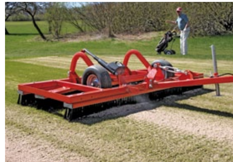
De Terra Groom is een nieuwe getrokken bezem van Wiedenmann voor het invegen van zand en granulaat. Hij weegt 90 kg en werkt 187 cm breed. Ook toont Wiedenmann een rijafhankelijke tapijstroofier.
