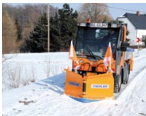
Fiedler heeft ook een nieuwe FKP-serie sneeuwschuiven. Bij deze is het midden pot-dicht afgesloten door een kunststof cilinder. De prijs is vanaf 3.100 euro.
