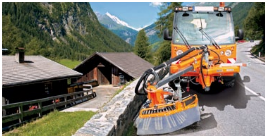
Nieuw van Fiedler is de FWK 900 onkruidborstelarm. Die kan 180 graden zwenken via een ketting en twee cilinders. Het werkbereik is 380 cm; de zwenkhoek is in te stellen. Voor transport vouwt hij op. Hij weegt 300 kg en kost inclusief de nieuwe multimatic-control FMC circa 10.000 euro.
