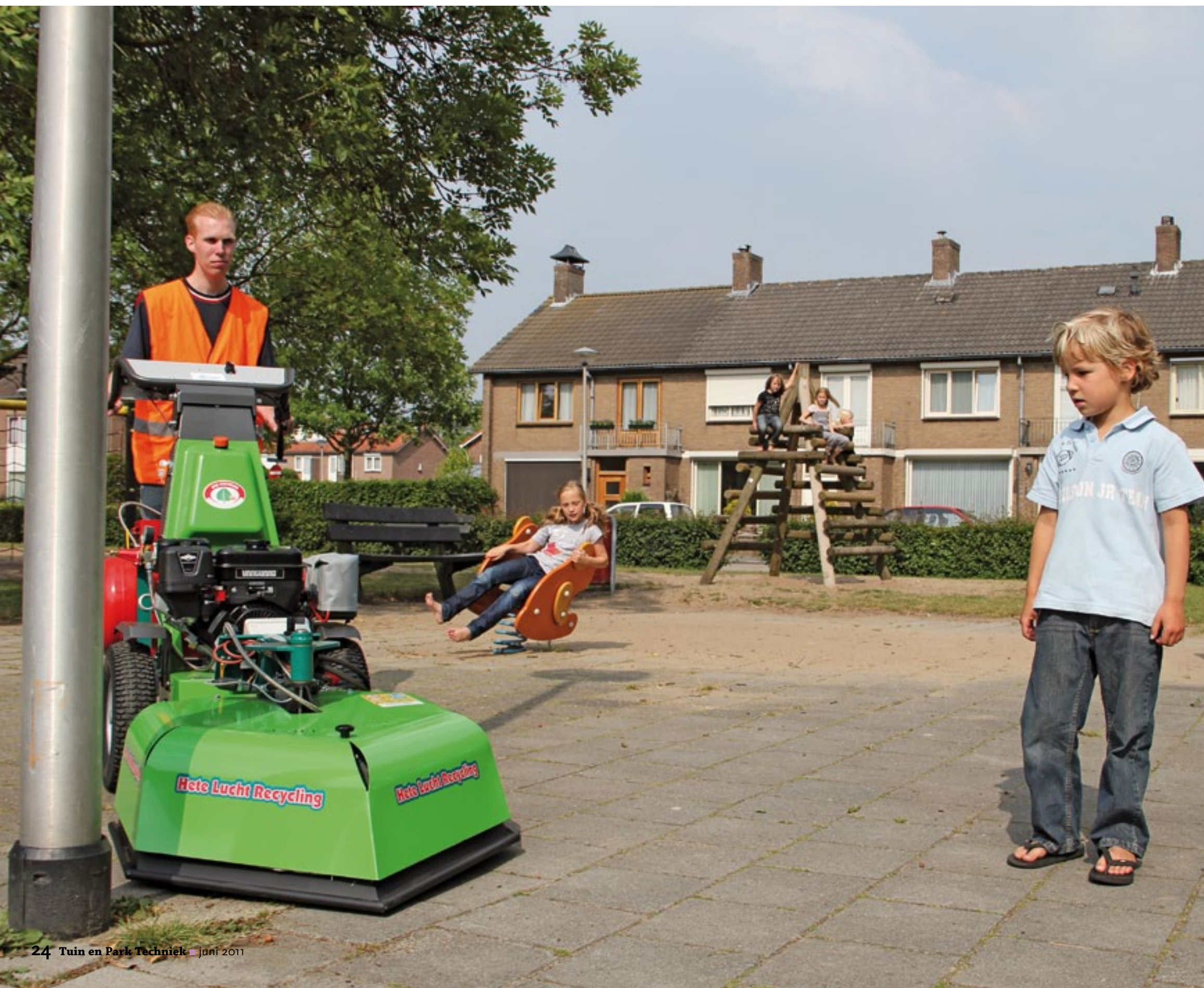
De heteluchtrecyclingbak is te draaien, waardoor je makkelijker langs een kant het onkruid kunt bestrijden.
