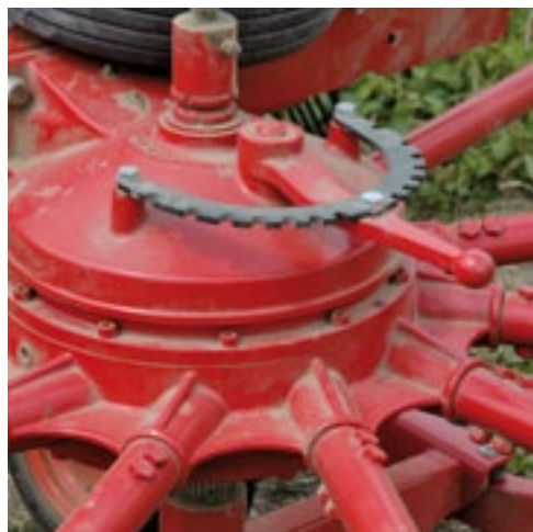
■ Een voordeel van de F.C.R. hark is de betrekkelijk kleine (gesloten) aandrijving. Licht gewicht is vooral door de hefboomwerking aan een helling een voordeel.
