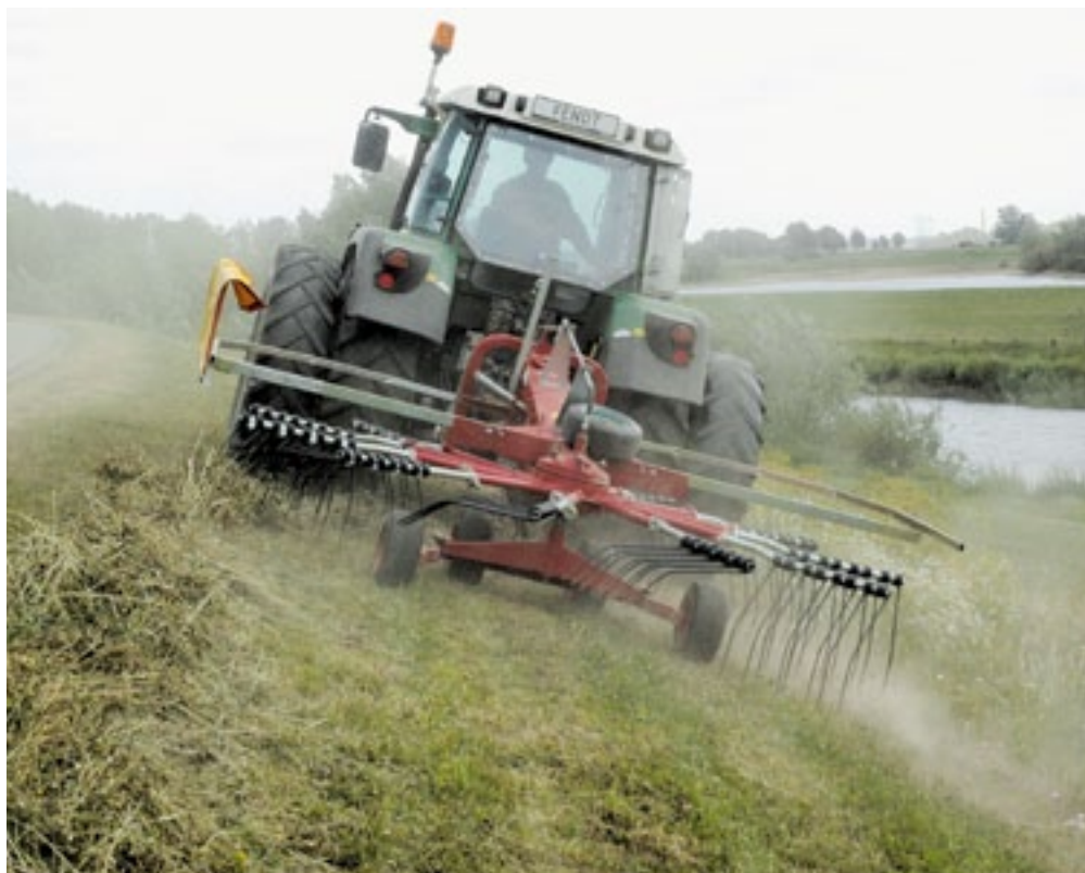
■ Een standaardrotorhark met kleine diameter is simpel en betaalbaar en heeft ten opzichte van een acrobaat het voordeel dat hij blijft harken als de trekker stilstaat. Een degelijk wielstel is in de berm een plus.
