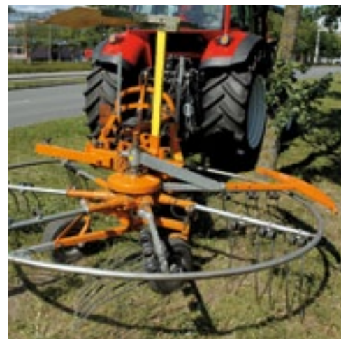
■ Zowel de Abimac als de F.C.R. sidschift-machine heeft een extra bescherming voor botsen met palen en bomen en een beschermbeugel rondom de rotorarmen.
