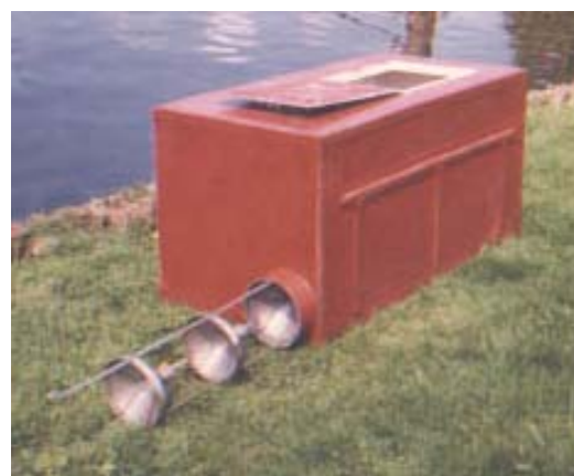
Figuur 5-c In de vernieuwde val in Vollenhove is de wilgenbaan vervangen door een uitstroomopening onder het water, afgesloten door een aantal stalen trechters, vergelijkbaar aan de kelen in een fuik.
