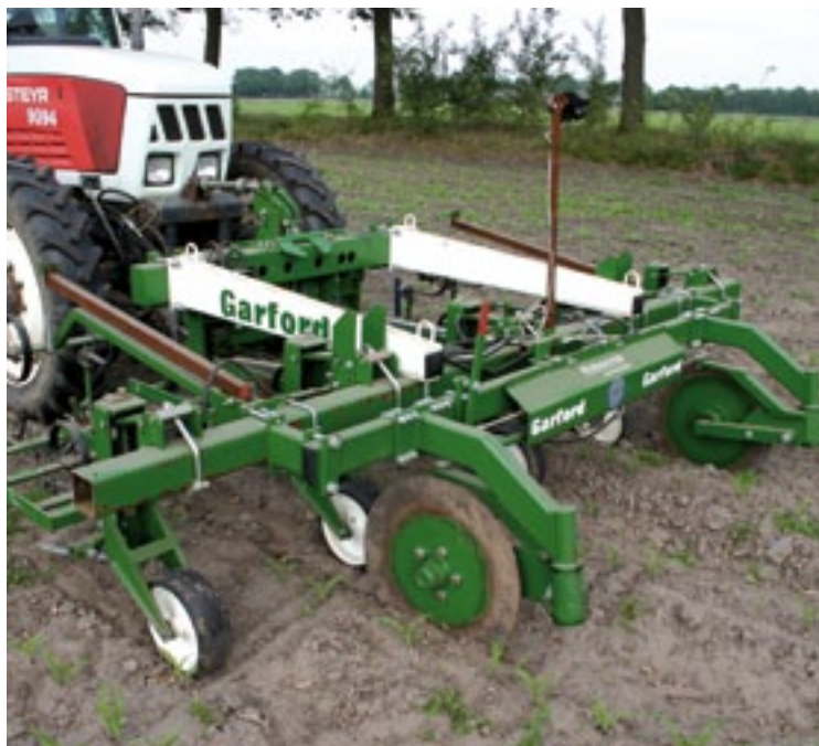
▲ De twee stuurschijven worden op commando van de camera via de computer aangestuurd.
