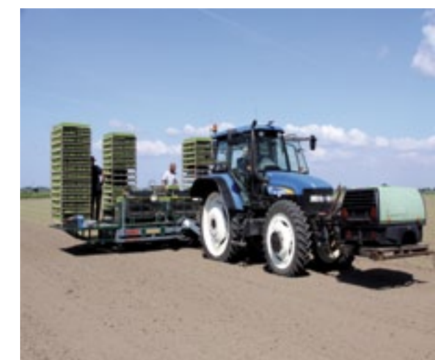
▲ Een compressor voorop de trekker levert de luchtdruk voor het systeem. Daarnaast wordt hij gebruikt om de machine schoon te blazen.
