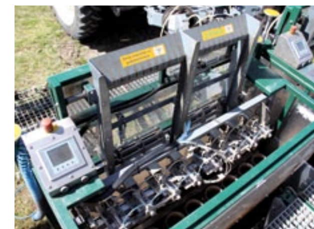
▲ Naast elke serie elementen zit een bedieningspaneel van Siemens. Hiermee is de machine direct te bedienen.
