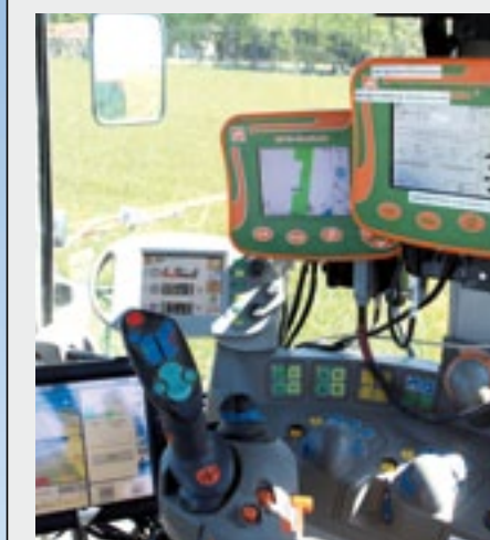
▲ Diverse monitoren in de vier jaar oude Fendt 818. De computer van Trimble met rtk-gps, nieuwste FmX display en twee monitoren van Amazone.
