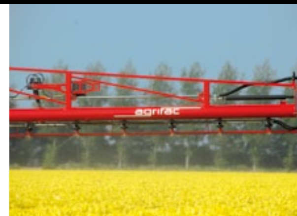
▲ De ronde stalen buis is kenmerkend voor de spuitboom. Agrifac dicht aan zijn constructie stabiliteit toe en dus een constant spuitbeeld.
