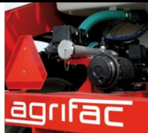
▲ Pompen, filters en kranen zitten dicht op elkaar en minimaliseren de hoeveelheid restvloeistof. Agrifac noemt dat principe GreenFlowPlus.
