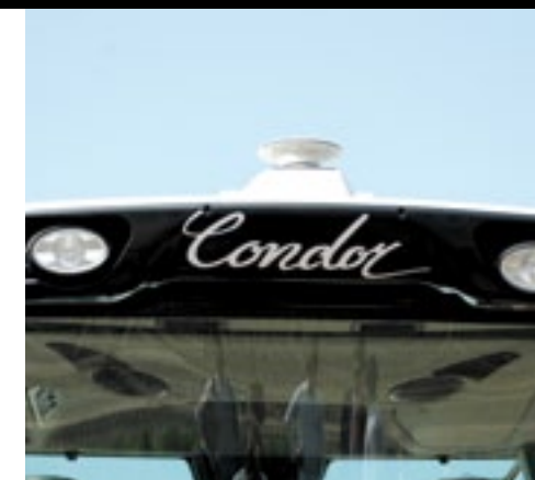
▲ De cabine komt van Claas. De gps-ontvanger is standaard en stuurt naast de wielen ook de automatische sectie- of dopafsluiting aan.
