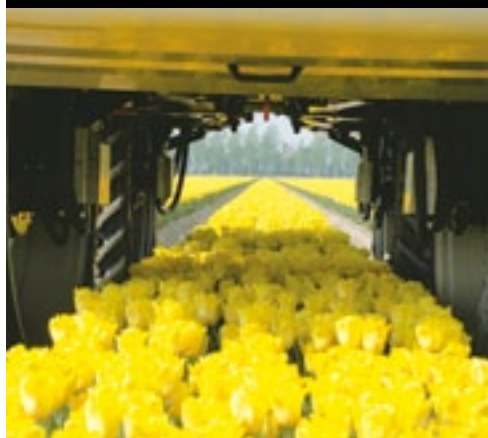
▲ De bodemvrijheid van de nieuwe Condor is 125 cm tegenover 110 cm bij de oude. De onderkant van de machine is nagenoeg vlak.
