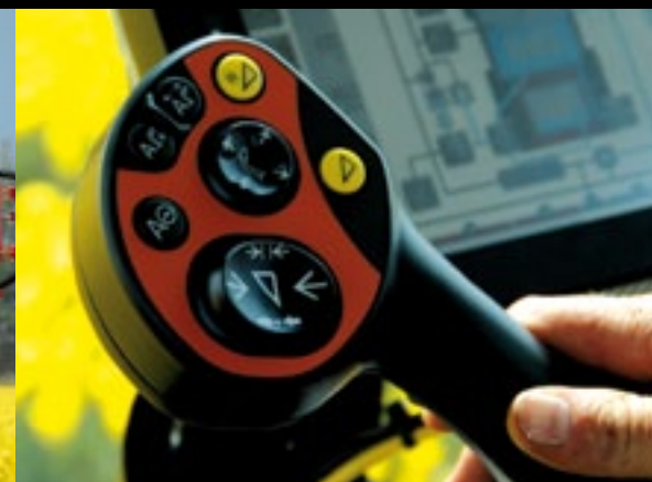
▲ De multifunctionele hendel (joystick) bedient onder andere de rijfuncties, de boom, de balanscorrectie en het spuiten.
