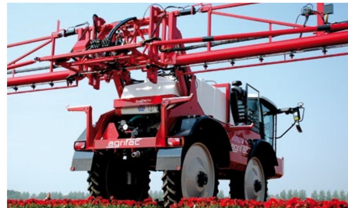
▲ De spoorbreedte is traploos instelbaar tussen 150 en 225 cm; de gepatenteerde wielophanging laat alle bewegingen in één punt samenkomen. Het BalancePlus balanssysteem is een van de betere in de markt.
