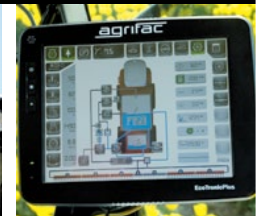
▲ EcoTronicPlus is de naam van het nieuwe touchscreen, waarop ook schematisch de vloeistofstromen te zien zijn.
