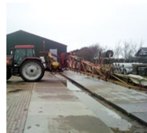
▲ Bij een betonnen opvangbak is ook bij een uitgeklapte spuit alle restvloeistof op te vangen.
