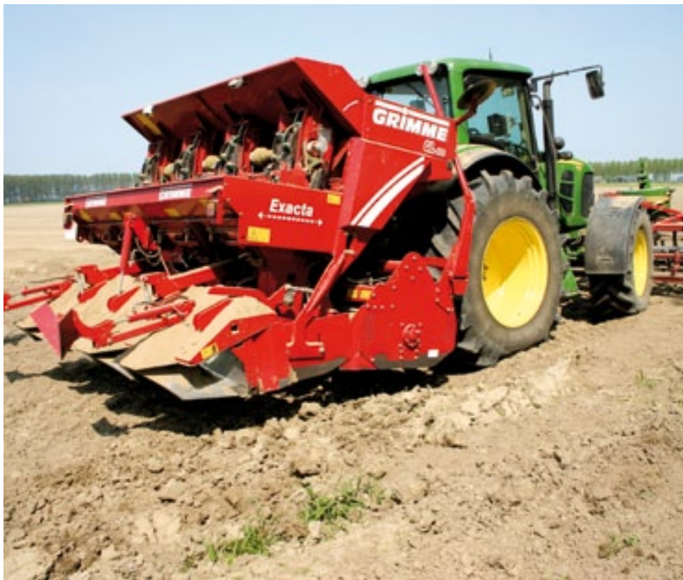
▲ Opvallend is de compacte bouw. Grimme haalt de bunkerinhoud uit de hoogte, zodat de hefboom een stuk korter is dan die van andere machines. Ondanks deze constructie zijn extra frontgewichten nodig.
