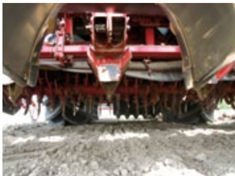
▲ De poters worden na de frees kort boven de grond gelost, toedekschijven ontbreken.
