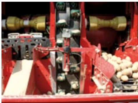
▲ Twee bandjes leiden de aardappelen naar de pootelementen. Een sensor meet het niveau.
