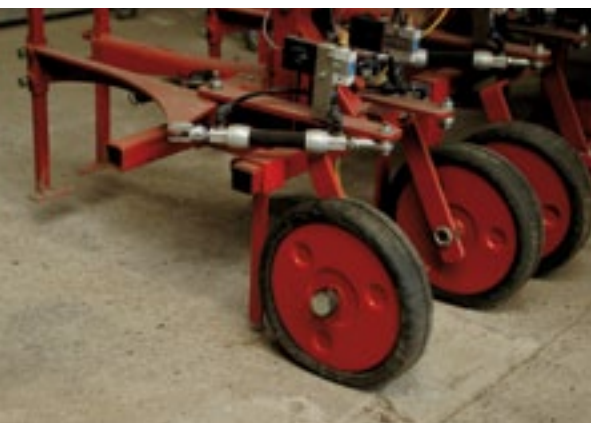
▲ De Sarl Radis waarmee het PPO onderzoekingen doet is nu (links) voorzien van twee schoffels en van zogenoemde 'spiercilinders'. Die worden dikker wanneer er luchtdruk op komt en daardoor tegelijkertijd korter. Dat werkt effectiever dan een pneumatische cilinder.
