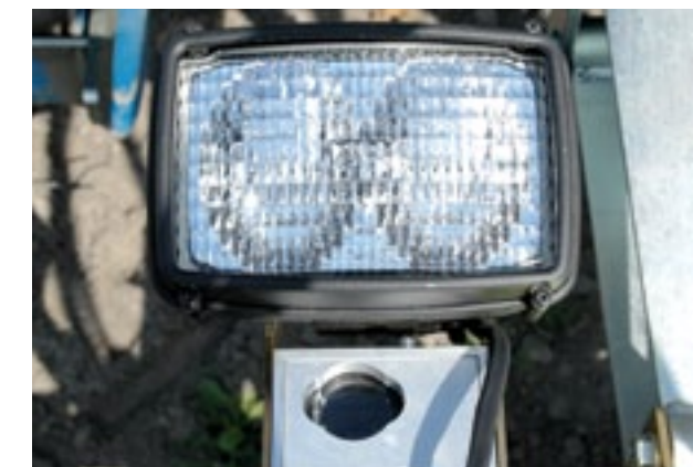
▲ Een felle lamp bij iedere camera (het donkere oog) maakt de werking daglichtonafhankelijk.
