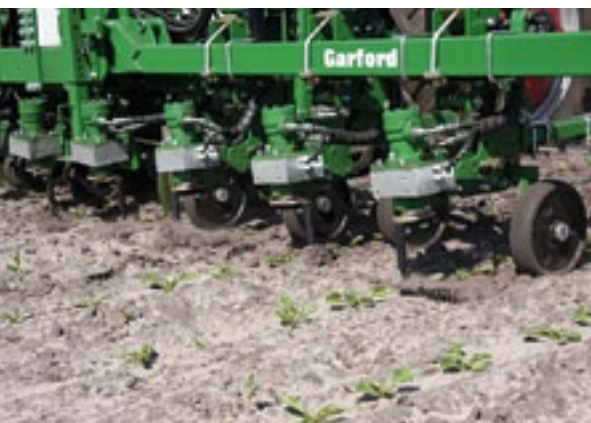
▲ De 12-rijige Robocrop Inline van Haaijer in actie in suikerbieten. Drie camera's die elk vier rijen 'spotten' vertellen de schoffel waar een plant staat. De centrale schoffel (in de rij) draait daar dan precies op het goede moment omheen.
