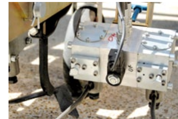
▲ Hoogwaardige pneumatische ventielen sturen de armen met daaraan de schoffelmesjes.
