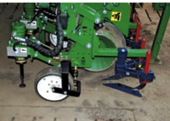
▲ De Garford Robocrop Inline werkt normaal gesproken met een hoefijzervormig mes dat vliegensvlug om de plant heen draait. Bij deze versie bij loonbedrijf Haaijer is dat mes vervangen door een prototype van een rond mesje (links op de foto) voor gebruik in cichorei.
