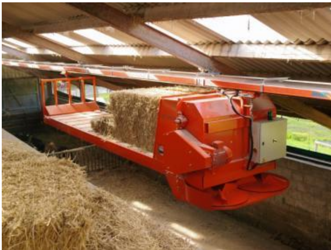
Figuur 5 Voorbeeld van een automatische stroverdeler voor potstallen
