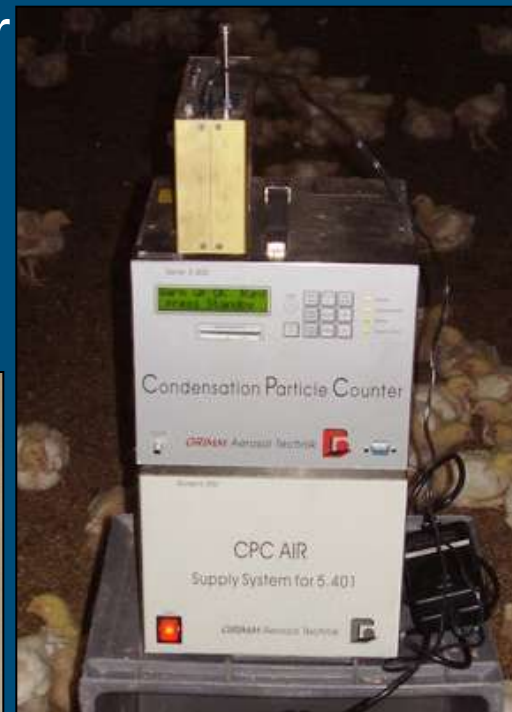
Portable Aerosol Spectrometer (model 1.108) en Condensation Particle Counter (model 5.400) (Grimm Aerosol Technik, D); tellen aantallen deeltjes per cm 3 in afz. grootteklassen
